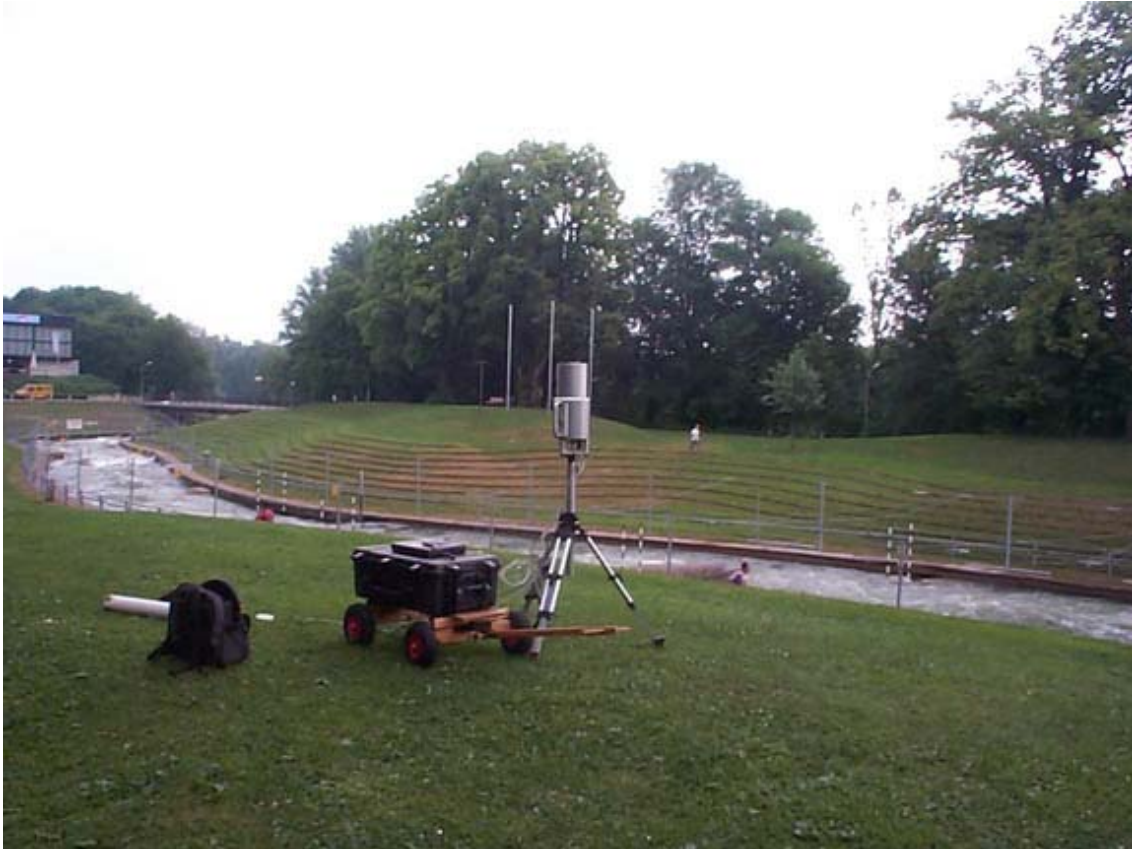
Abbildung 13: Handwagen und Koffer zum Transport von Scanner, Stativ und Laptop
