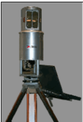
Abbildung 11: Laserscanner RiegI LMS Z210 auf Stativ mit Laptop [ http://www.ostenrieder.de , 20.11.2003]
