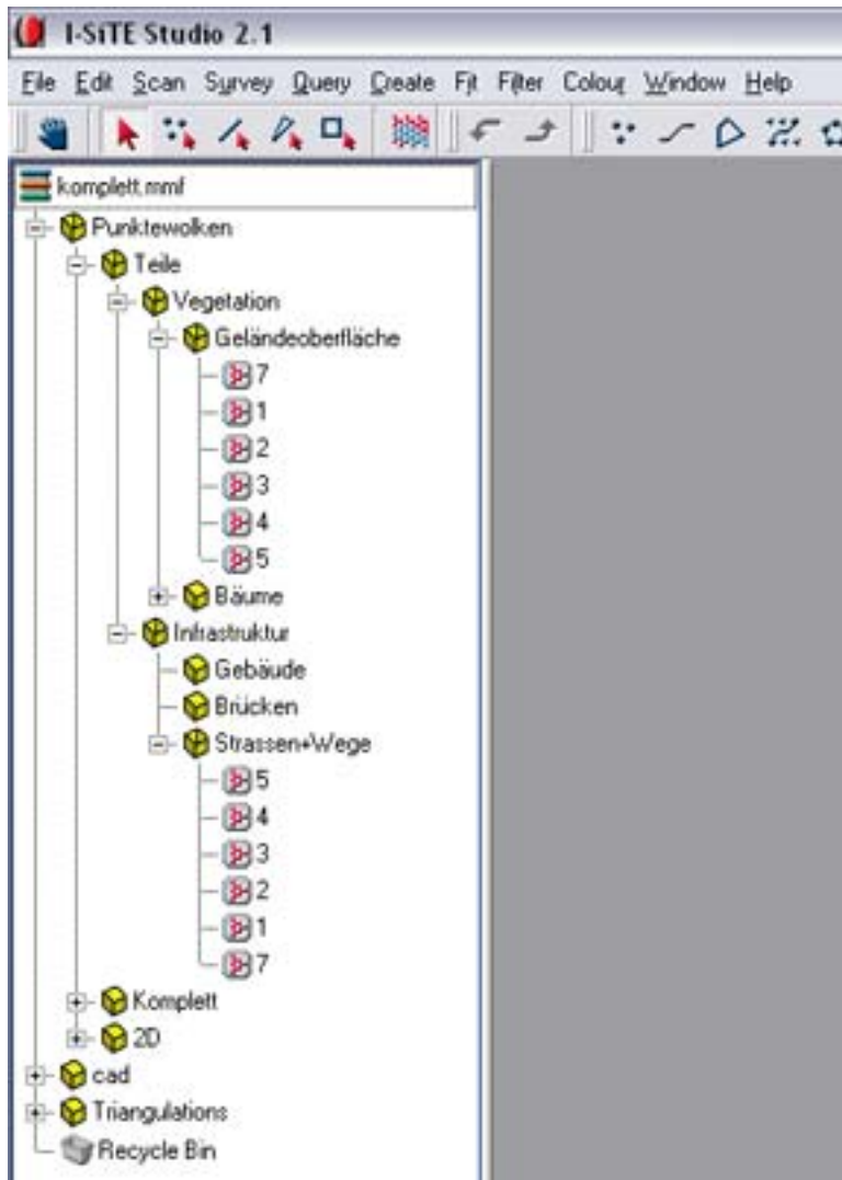
Abbildung 38: Separierung der Geobjekte in I-SiTE Studio 2.1
