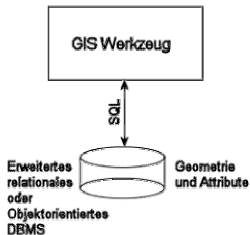
Abb.2.2: Schema eines GIS Systems der dritten Generation – integrated architecture („Geodatabase“)
