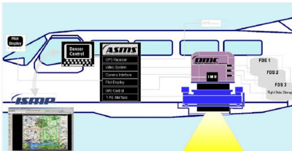
Abbildung 3 : Bildflug-Management System der Firma Z/I Imaging
