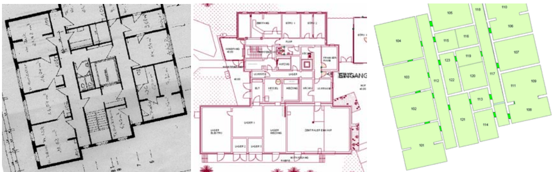
Abbildung 6.6 Grundrisserstellung (georeferenzierte Zeichnung, CAD-Plan, Grundriss in ArcMap)
