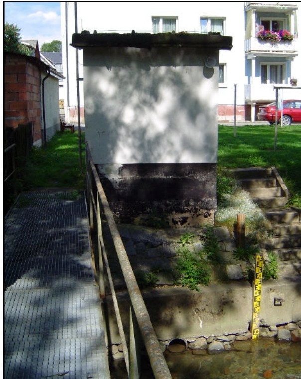
Abbildung 33: Schreib- und Online-Hochwassermeldepegel in Steinach am Gewässer Steinach. Foto R. Stahlmann, 20.08.2004
