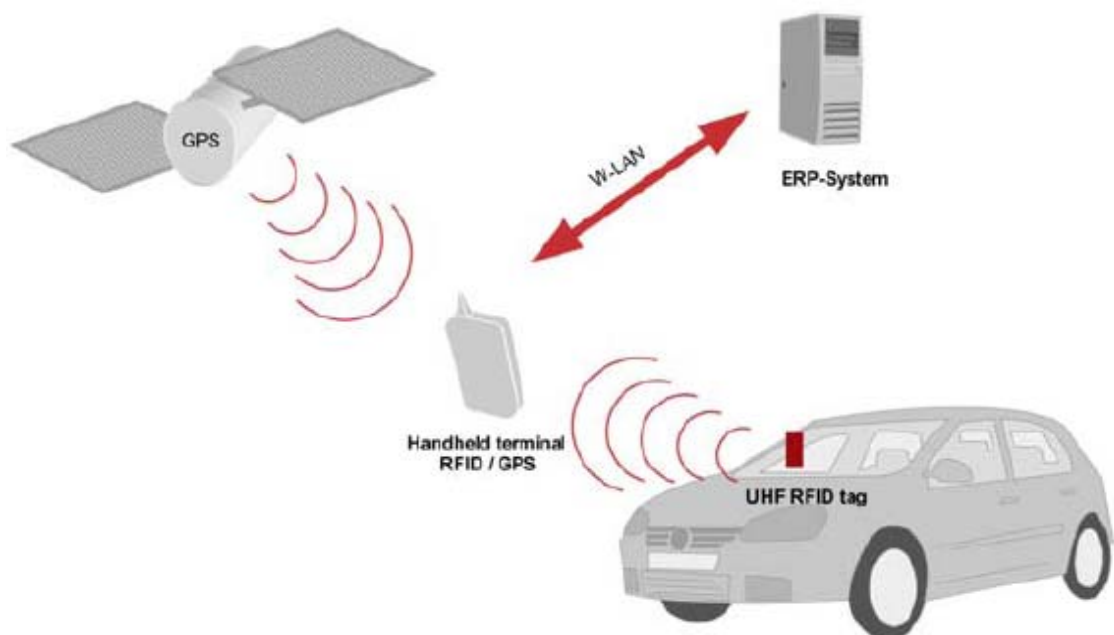
Abbildung 24: Hybrides RTLS mit RFID und GPS
