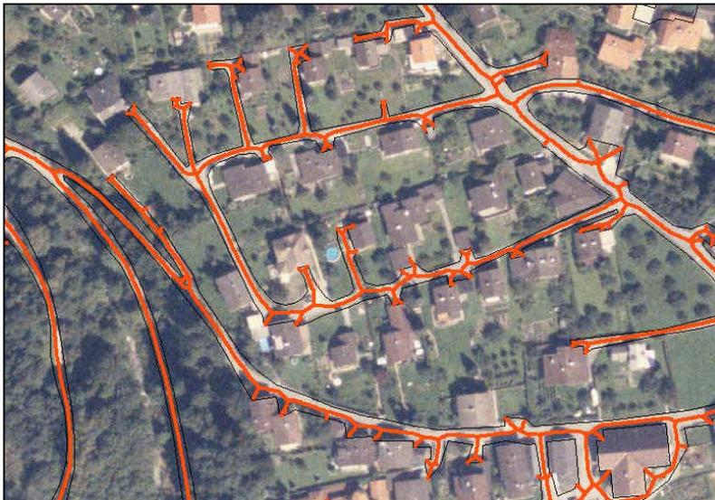
Abb 42: Automatisch abgeleitete Straßenachsen auf Basis Lage / Höhenplan– Bereiche brauchbarer Polygonstrukturen
