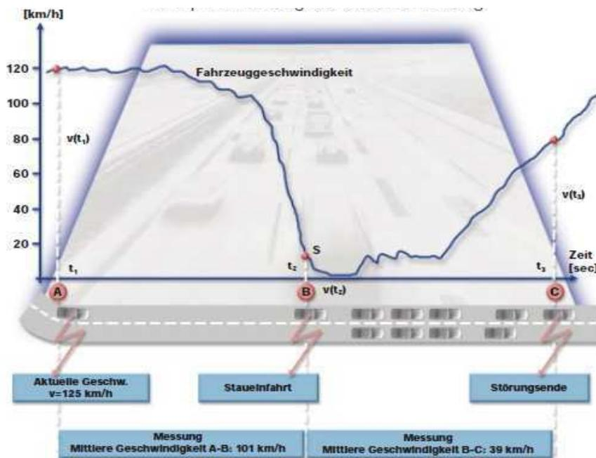
Bild 3.1: Prinzip der FCD Erfassung nach BMW AG AK-2 (1999: 2)
