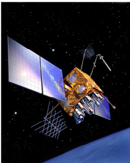
Abbildung 4: GPS-Satellit Block IIR/IIR-M [6,13]
