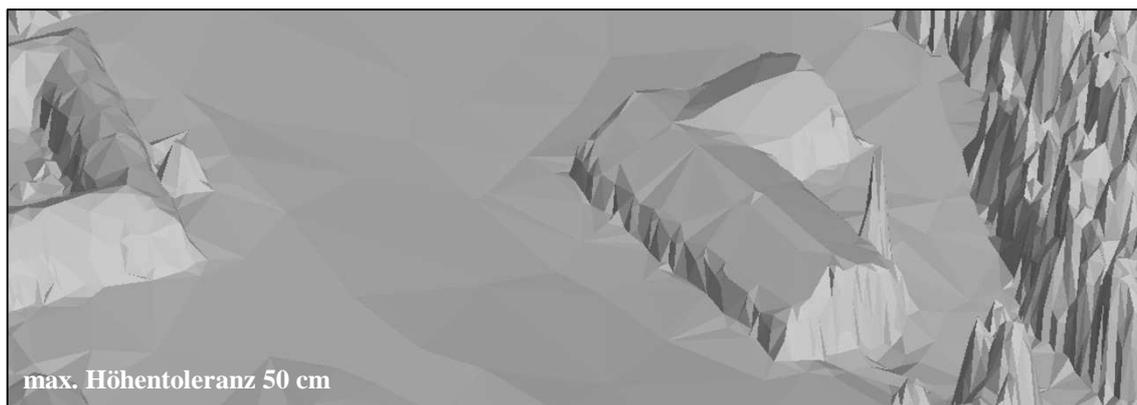
Abb. 4-4: Datenreduktion mit unterschiedlicher max. Höhentoleranz
