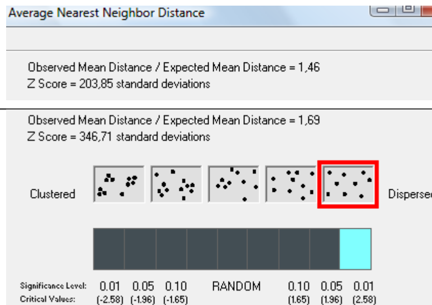
Anhang-Abb. 4: Nearest Neighbor Analysis Testgebiet Budapest mit vektorisierter topographischer Karte (1:10.000). Oben: Ergebnis ohne zusätzliche Berücksichtigung von OSM; Unten: mit OSM.
