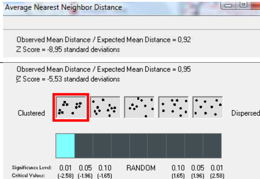
Anhang-Abb. 6: Nearest Neighbor Analysis des Testgebiets Aostatal mit russischer topographischer Karte (1:50.000). Oben: Ergebnis ohne zusätzliche Berücksichtigung von OSM; Unten: mit OSM.
