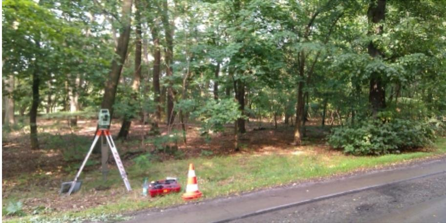
Abbildung 12: Tachymetrische Referenzmessung
