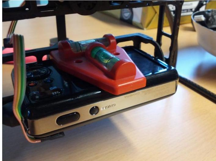
Abbildung 30: Untersuchung der Kameraausrichtung
