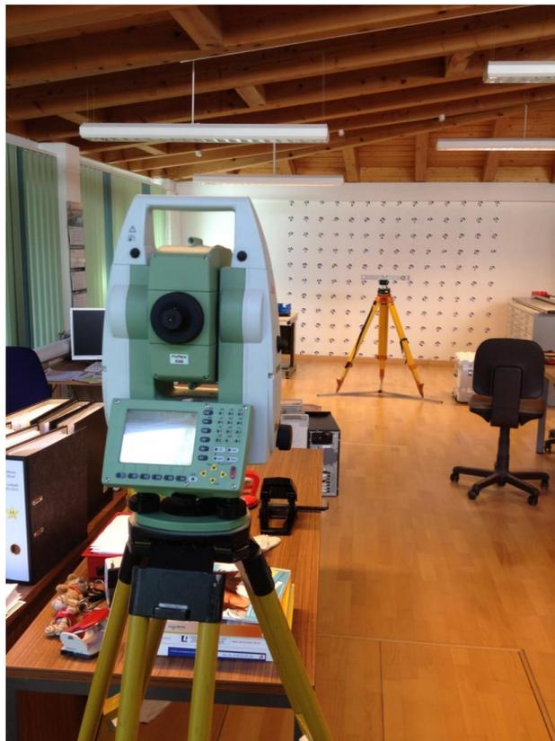
Abbildung 39: Ausrichtung der Kamera im Abstand von 2m zur Wand
