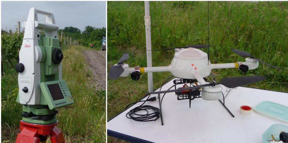
Abbildung 48: Standpunktbestimmung und Anbringen der Miniprismen
