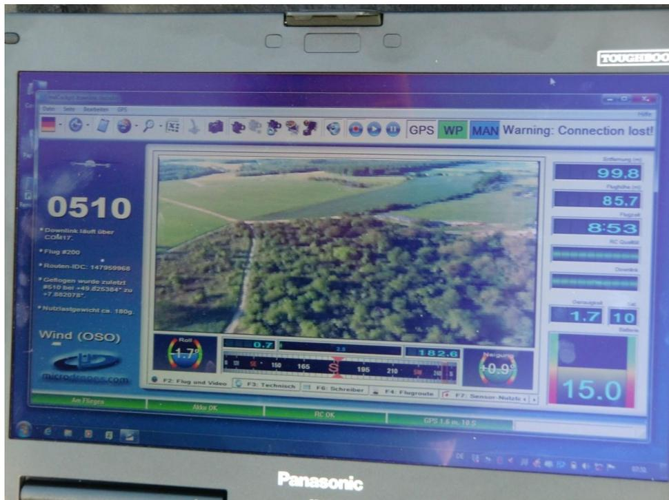
Abbildung 9: Der Downlink-Decoder im Einsatz
