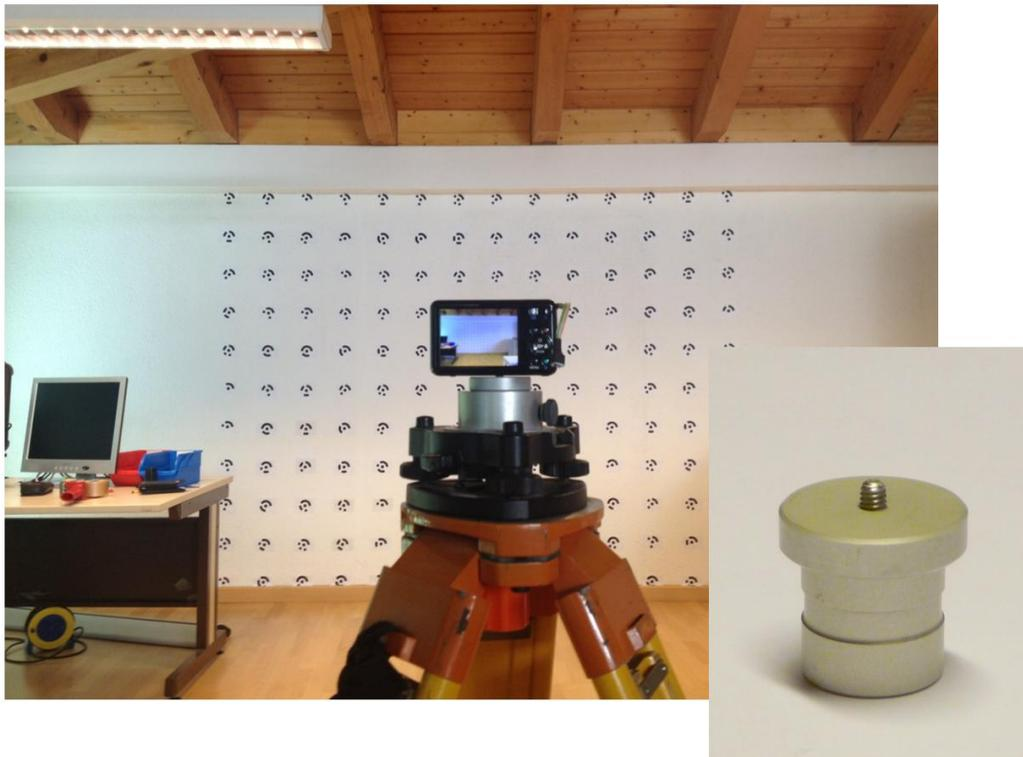
Abbildung 38: Mit einer eigens hergestellten Halterung konnte die Kamera auf dem Dreifuß eines Vermessungsstativs aufgebaut werden.
