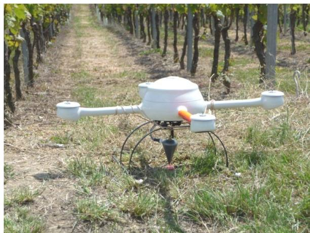
Abbildung 32: Das UAV zentriert über dem Kontrollpunkt
