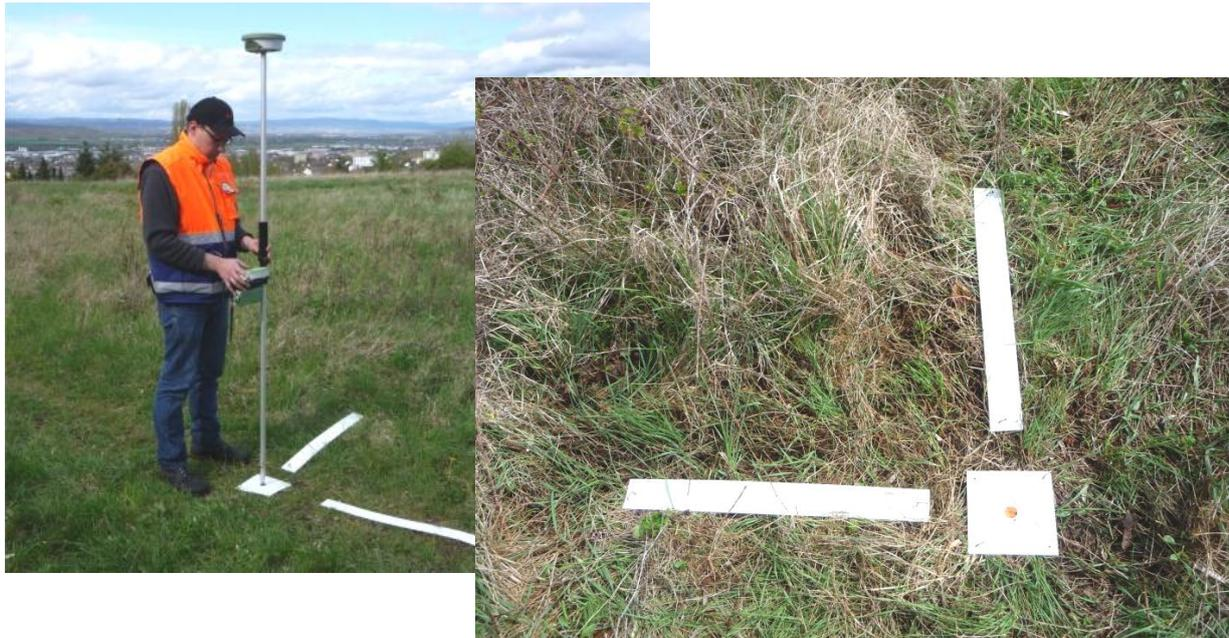
Abbildung 26: Herstellung der Referenzpunkte
