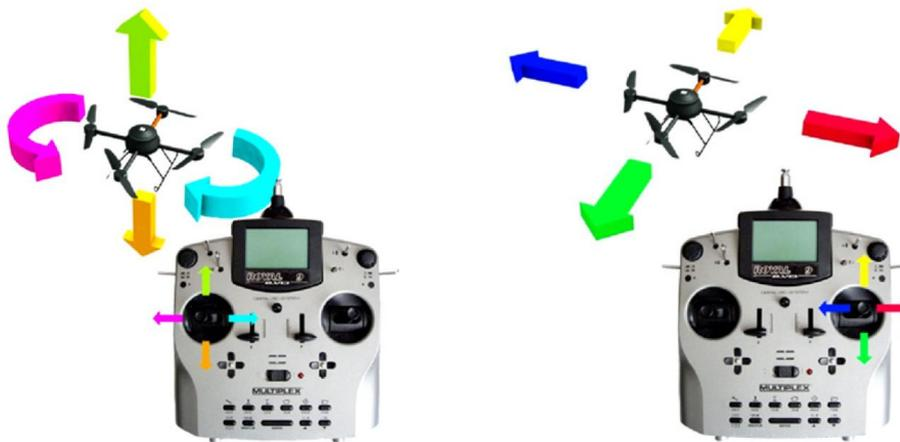
Abbildung 6: Steuerung der Drohne über die Fernbedienung
