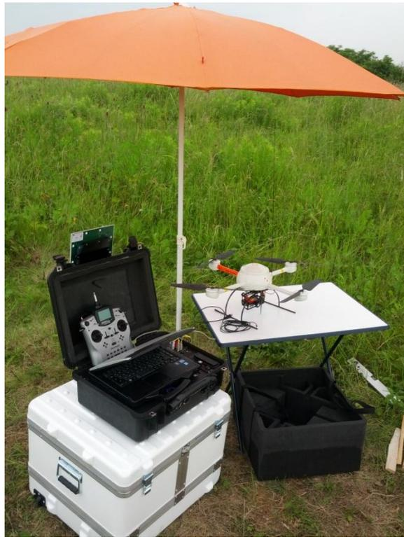
Abbildung 4: Komplettsystem md4-200 mit Drohne, Basisstation mit Notebook und Fernbedienung
