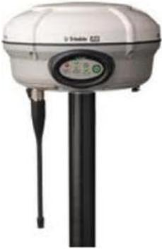
Abbildung 13: GNSS Trimble R8-3 [Allnav, 2006].
