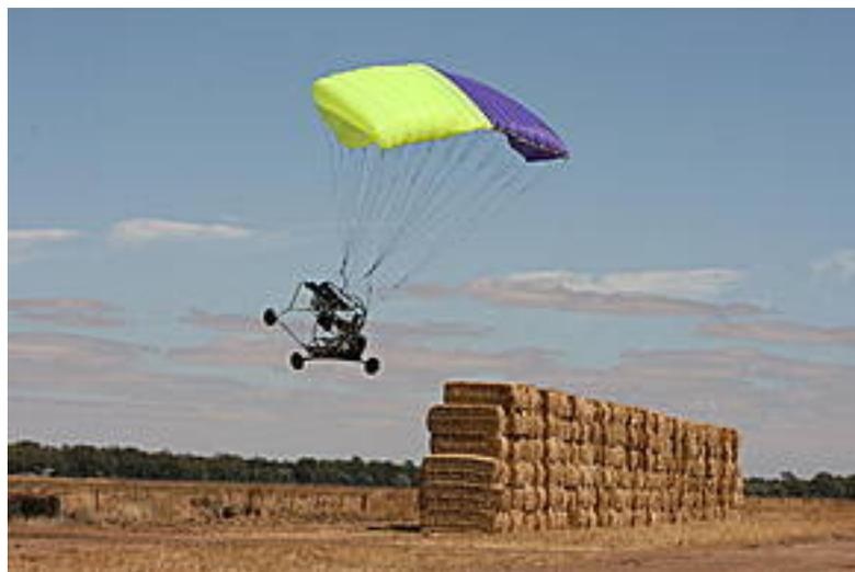
**Abb. 7:** „SUSI 62“: ein Gleitschirm-UAS von der Firma Geo-Technic (Quelle: [www.geo-uas.com](http://www.geo-uas.com))
