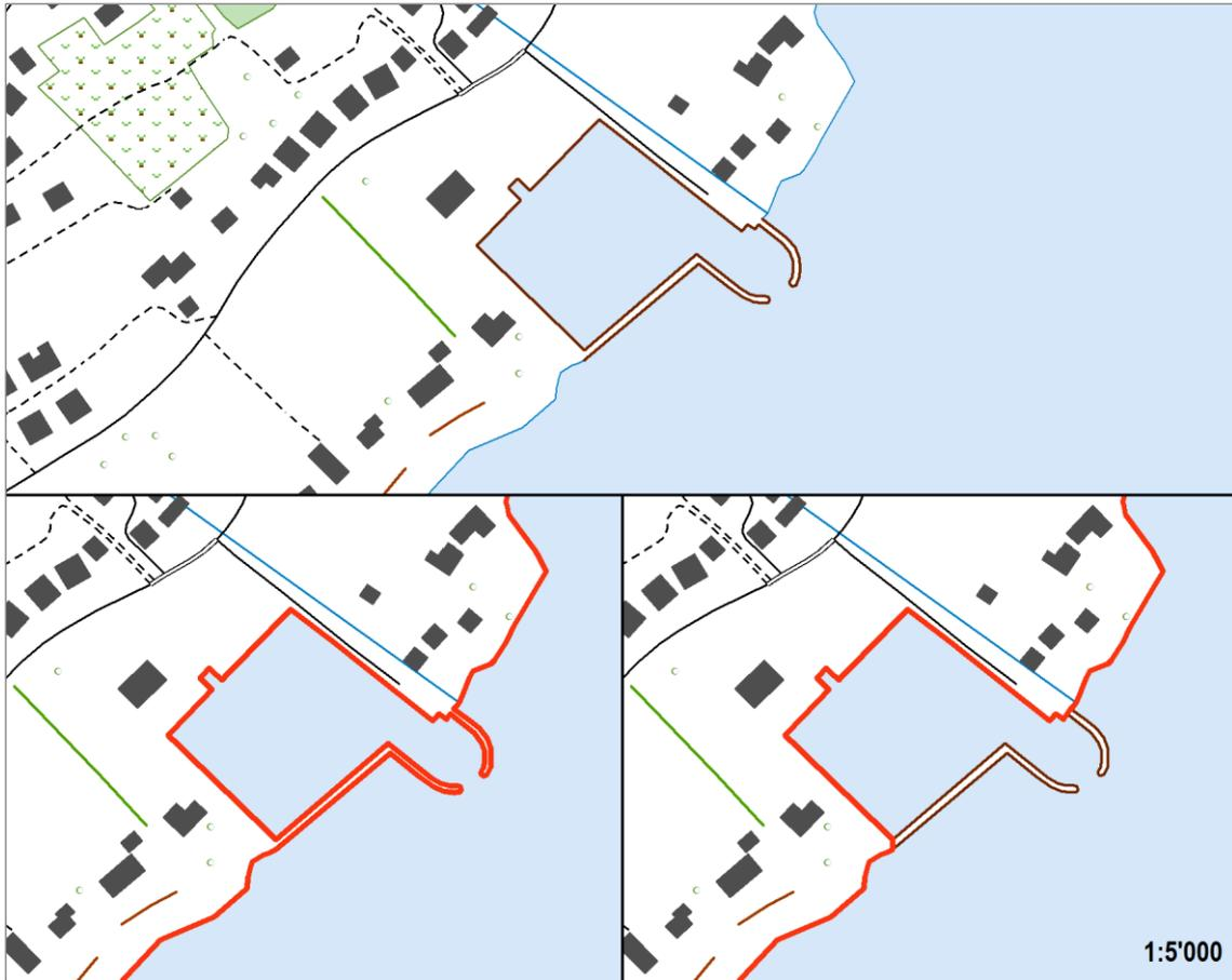
**Abb. 7** Die aus dem swissTLM3D (oben) automatisch extrahierte Uferlinie folgt Bauten im Flachwasser (unten links: rote Linie). Sie wird manuell vereinfacht (unten rechts: rote Linie).
