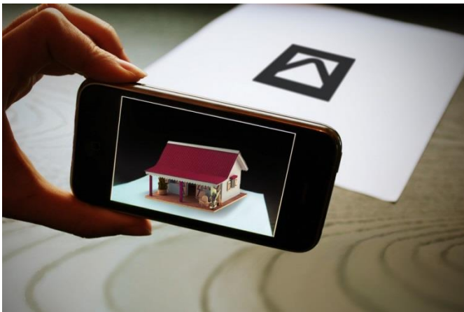
Abb. 17: Visuelles Tracking durch künstliche Marker (Quelle: www.arlab.com )
