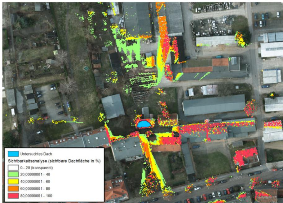
Abbildung 3-9 sichtbare Flächen ohne Reduzierung
