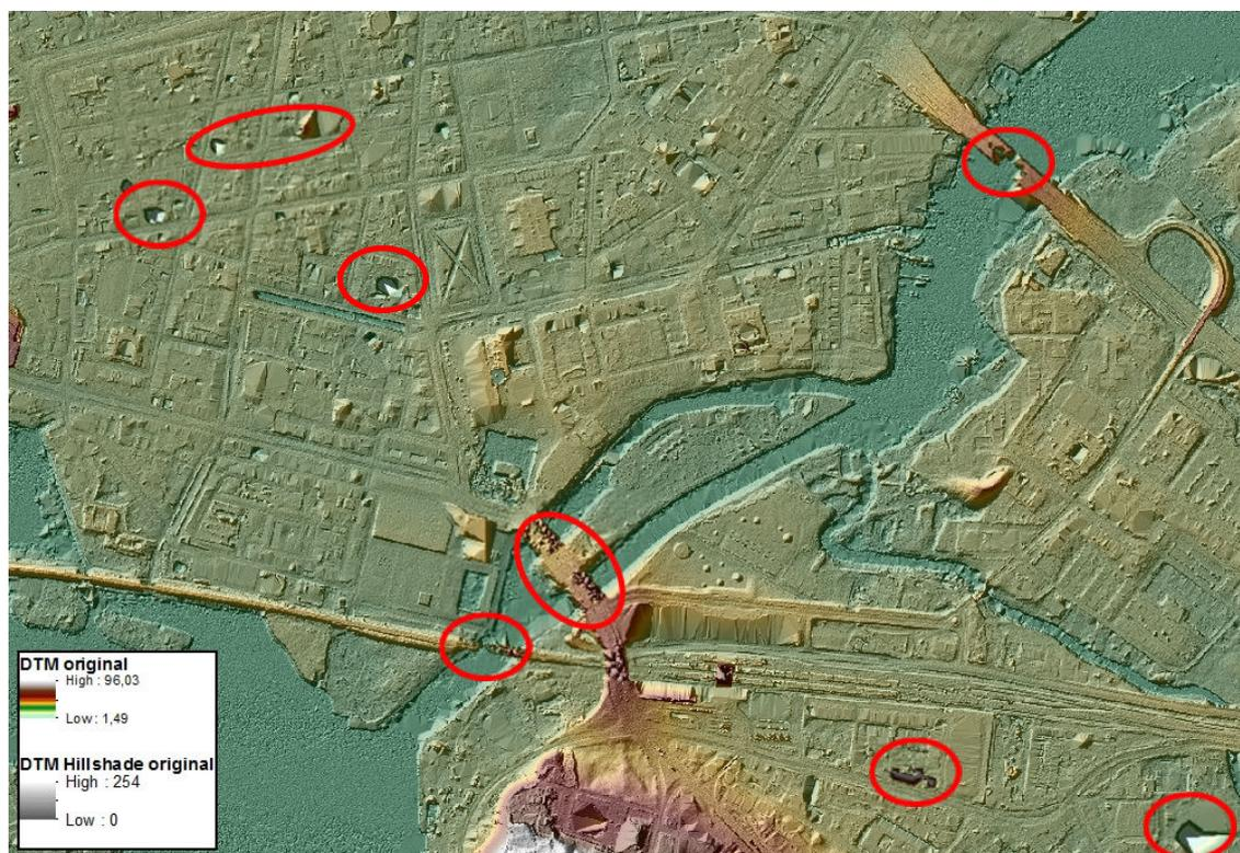
**Abbildung 2-12 Schattiertes und coloriertes DTM mit groben Fehlern (rot umrandet)**
