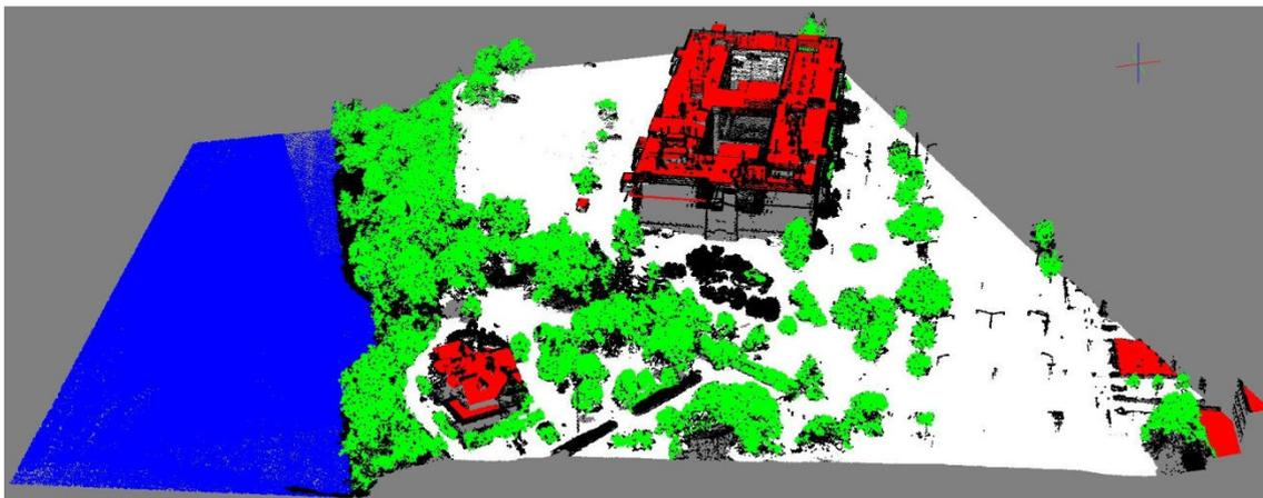
**Abbildung 2-10 Klassifizierte LIDAR Punkte (Gebäude in Rot, Bäume in Grün und Wasser in Blau), Quelle: Carlberg et al. (2008)**
