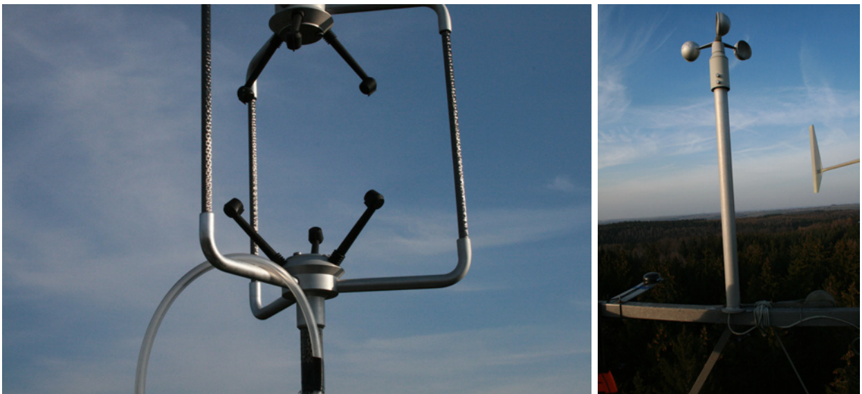
Abbildung 3.13: 3D-Ultraschall-Anemometer (links) und Schalen-Anemometer (rechts) des Messturmes
