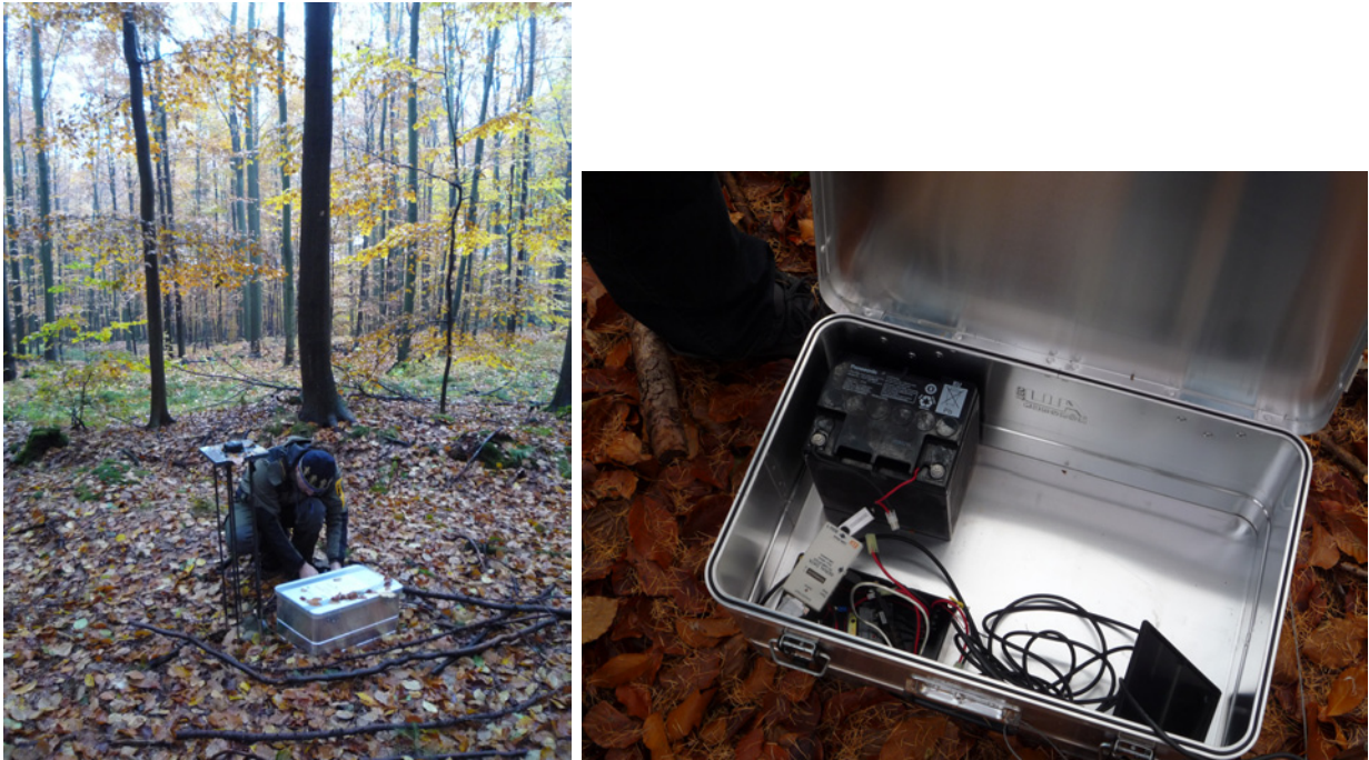
Abbildung 3.11: GPS-Empfänger im Buchenbestand am Pferdestall (links) und Kiste mit Datenlogger und Batterie (rechts)
