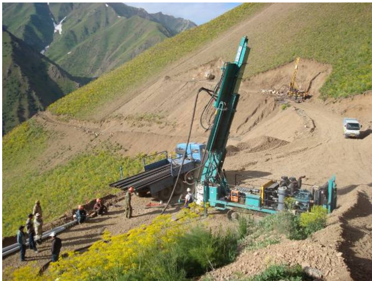
Abbildung 34: Laufende Bohrungen. Im Vordergrund ist ein RC- Bohrturm (reverse circulation rig), welcher Splitterproben (chips sample) fördert. Im Hintergrund ein Kernbohrturm, welcher Bohrkern liefert.
