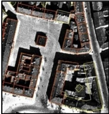
Abb. 4.4 Historisches Luftbild nach der Transformation in das ETRS89-Referenzsystem (Ausschnitt). Zur visuellen Überprüfung der Lagegenauigkeit dient der ALK-Datensatz. Bestehende historische Gebäude sind rot gekennzeichnet.
