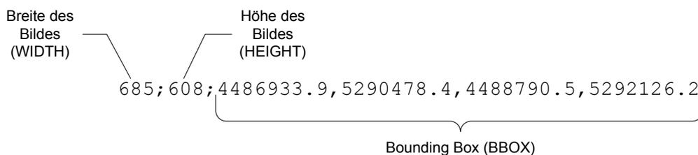
Abb. 28: Beispieldatensatz `wms_request.py` (eigener Entwurf)
