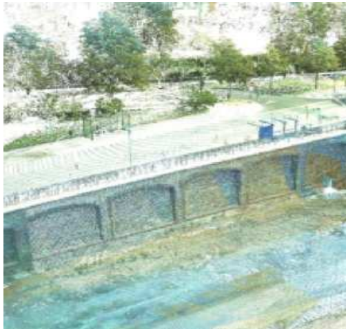
Abbildung 37: Darstellung einer 3D Punktwolke, die mit Hilfe des TLS-Verfahrens erstellt wurde; Quelle: Stadt Kassel, Vermessung und Geoinformation
