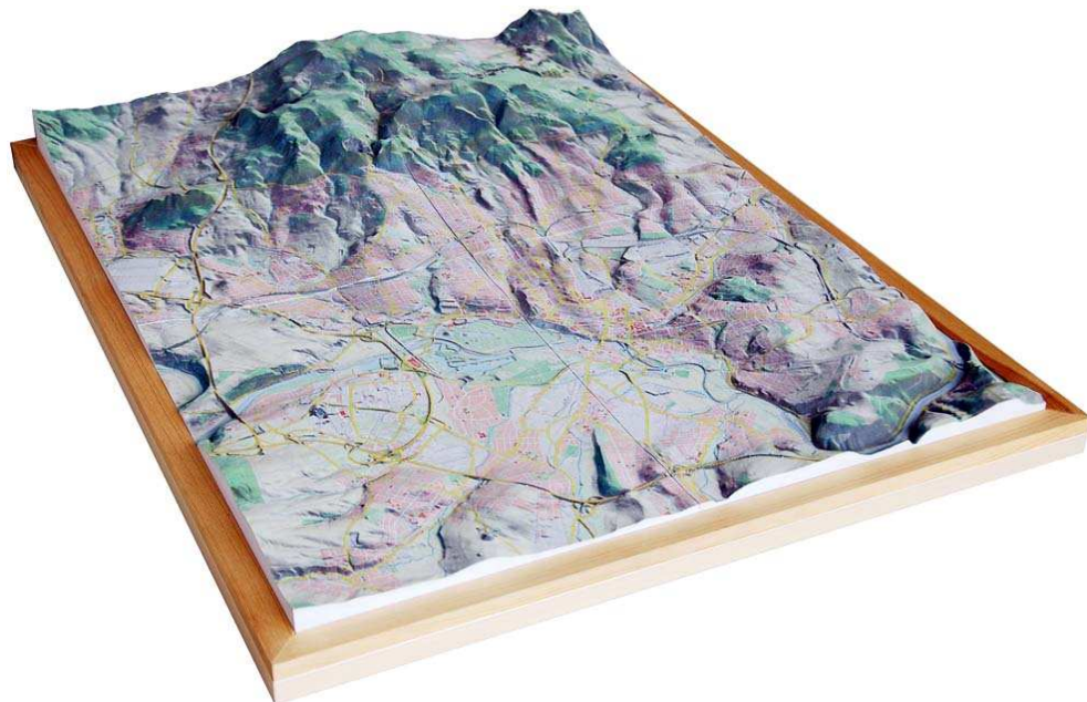
Abbildung 41: Anhand des Höhenrasters und der Amtlichen Stadtkarte wurde ein Gipsmodell im Maßstab von ca. 1:23.000 in 5-facher Überhöhung angefertigt; Quelle: eigene Aufnahme
