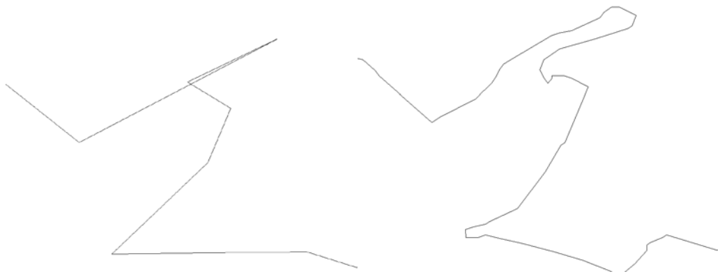
Abbildung 5-8: Fehler in der Linienvereinfachung aufgrund ungünstiger geometrischer Konstellationen
