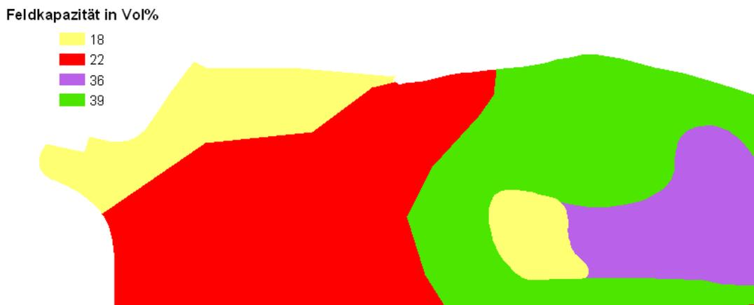
**Abbildung 17:** Feldkapazität für sandige Lehm Böden (36 und 39 Vol%) und für lehmige Sandböden (18 und 22 Vol%) für die GIS-SIMPEL Modellierung.
