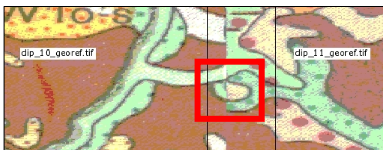
Abbildung 22: Kartenrandfehler der IQaME 2500 zwischen Blatt 10 und Blatt 11. Der Überarbeitungshinweis eines Karten Co-Autors zur Behebung des Fehlers kann der Abbildung 25 entnommen werden.
