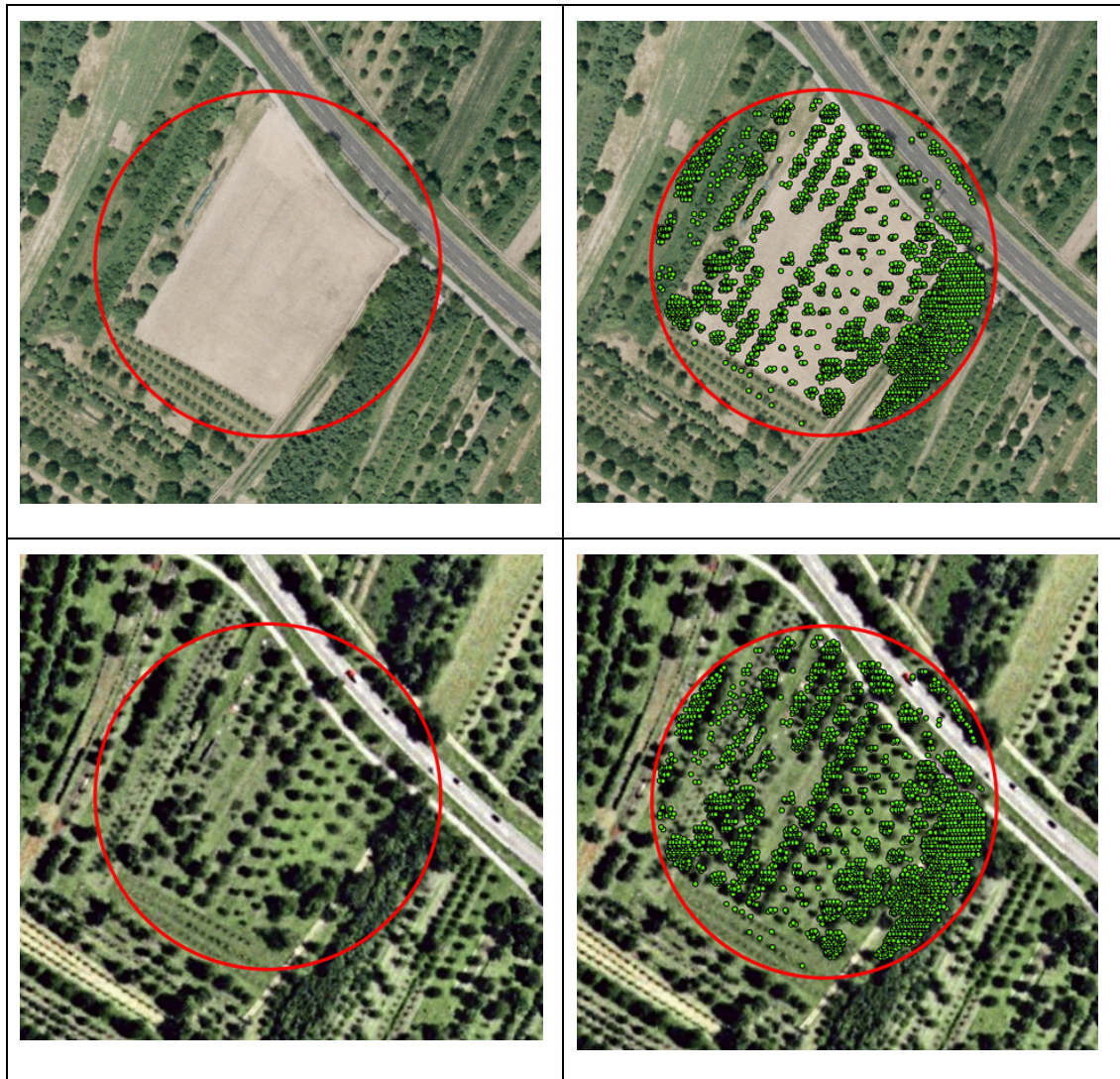
Abbildung 22: Verdeutlichung der zeitlichen Differenz von ALS-Daten und Orthophoto (oben) bzw. Google Earth (unten)
