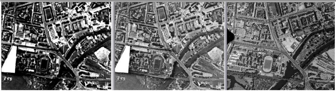
Abb. 35: Histogram Matching anhand des Mosaiks von 1974 (v. l. Screenshot vor der Anpassung, nach der Anpassung, Referenzbild von 1992) (©2009 BArch/1974 , Film-Nr. 205750, Bild-Nr. 116,118, ©2009 Landesluftbildsammelstelle der LGB)
