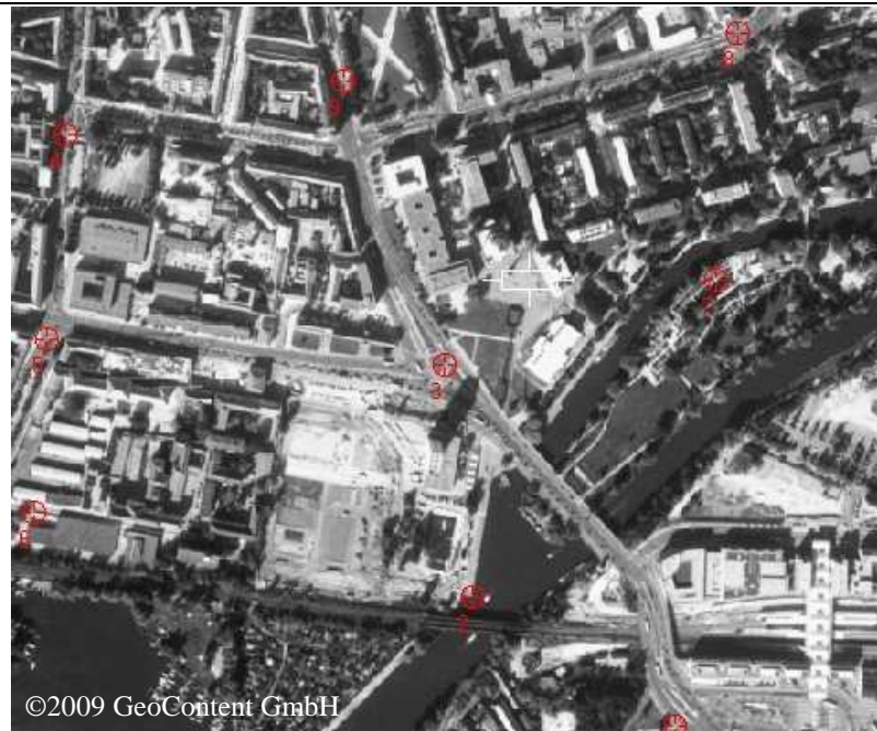
Abb. 40: Passpunktverteilung von 9 Passpunkten, Basis 2000 (Screenshot)
