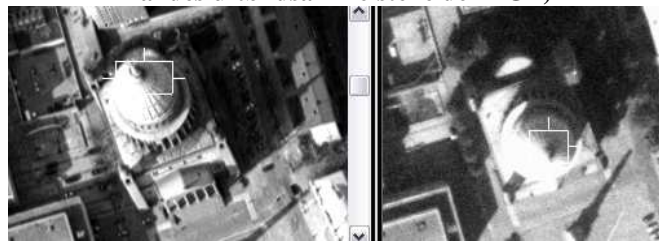
Abb. 43: Unterschiede in der Gebäudeverkipfung (links 1998, rechts 2000), (©2009 Landesluftbildsammelstelle der LGB, ©2009 GeoContent GmbH)
