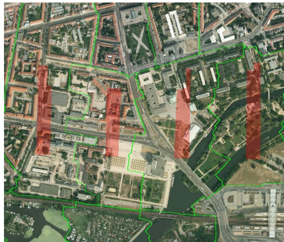
Abb. 27: Verlegung der Schnittkanten mit dem Seam Editor der Inpho GmbH (Screenshot)
