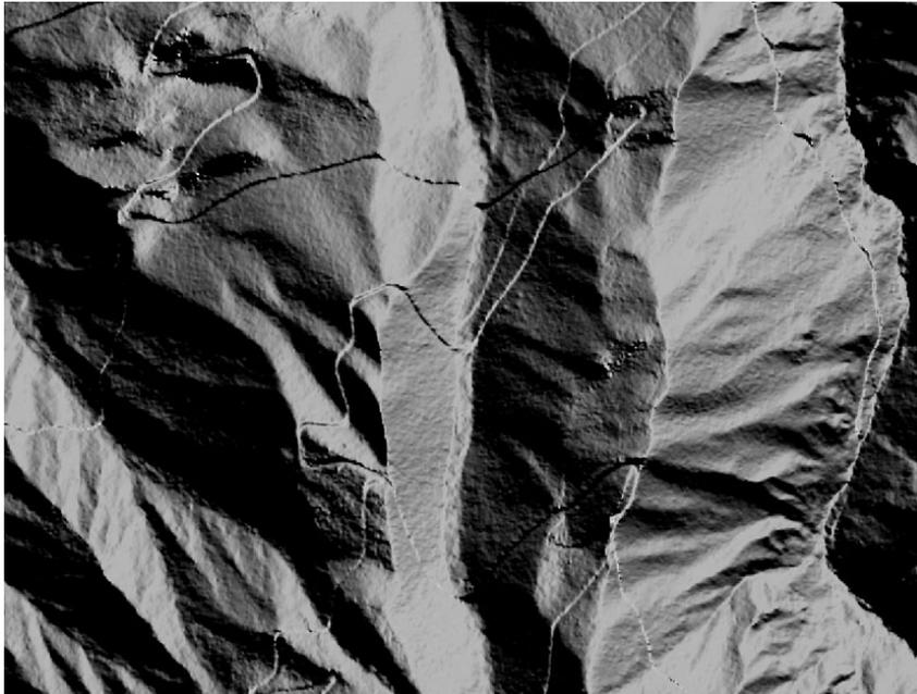
*Abbildung 27: Wege des vorherigen Ausschnittes im 1-Meter-digitalen Geländemodell (Hillshade). Unterschiedliche Beleuchtungen führen zu einer verbesserten Sichtbarmachung (Bearbeiter: O. Astner)*
