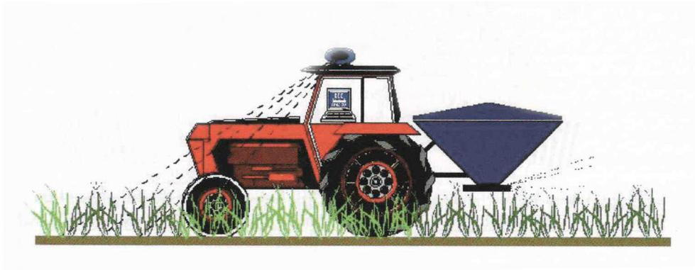
Abbildung 30: Stickstoff-Sensor-Düngung mit Messung, Berechnung und Ausbringung (aus: LUDOWICY et al. 2002, S. 121)
