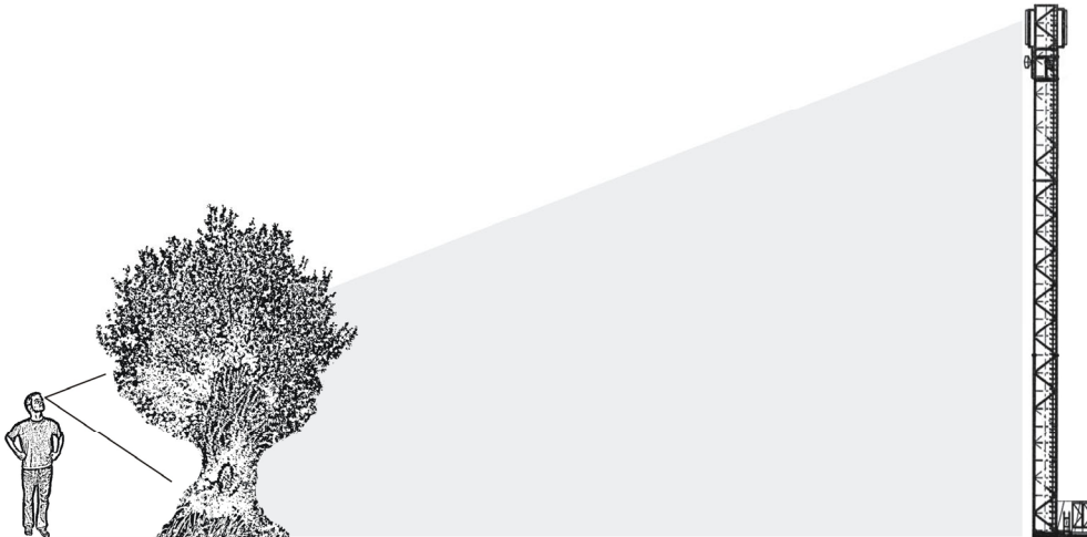
Abb. 2–9: Sichtverschattung durch die nah gelegene Sichtbarriere zum fernen Objekt
