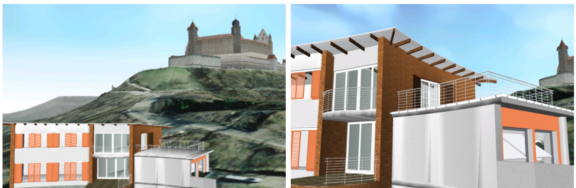
Abbildung 12: 3D-Stadtmodell Coburg mit Textur, Fassadendetails, Einrichtung im LOD 4 Quelle: eigene Abb., Stadt Coburg (2008)
