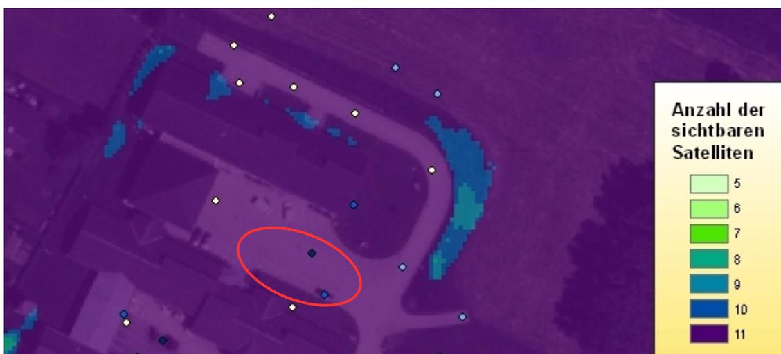
Abbildung 5.7: Simulation Anzahl der sichtbaren Satelliten mit DGM für den Zeitpunkt 31. Januar 2007, MEZ 8:48 und 8:49 Uhr
