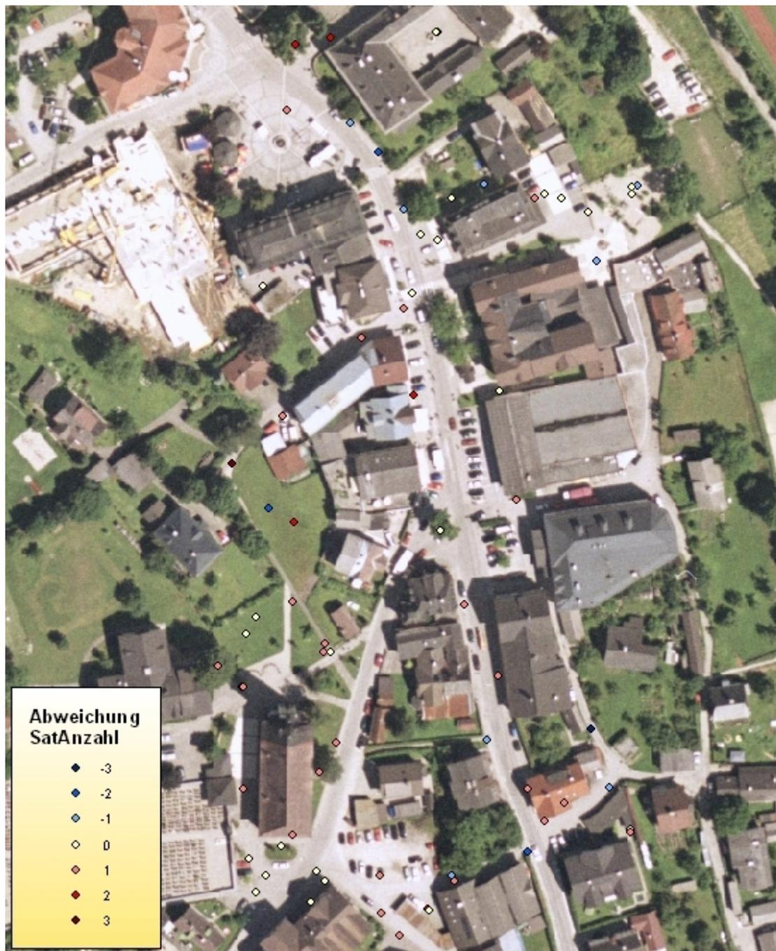
*Abbildung 5.2:* Visualisierung der gemessenen Kontrollpunkte in Bad Goisern mit hinterlegtem digitalen Orthophoto
