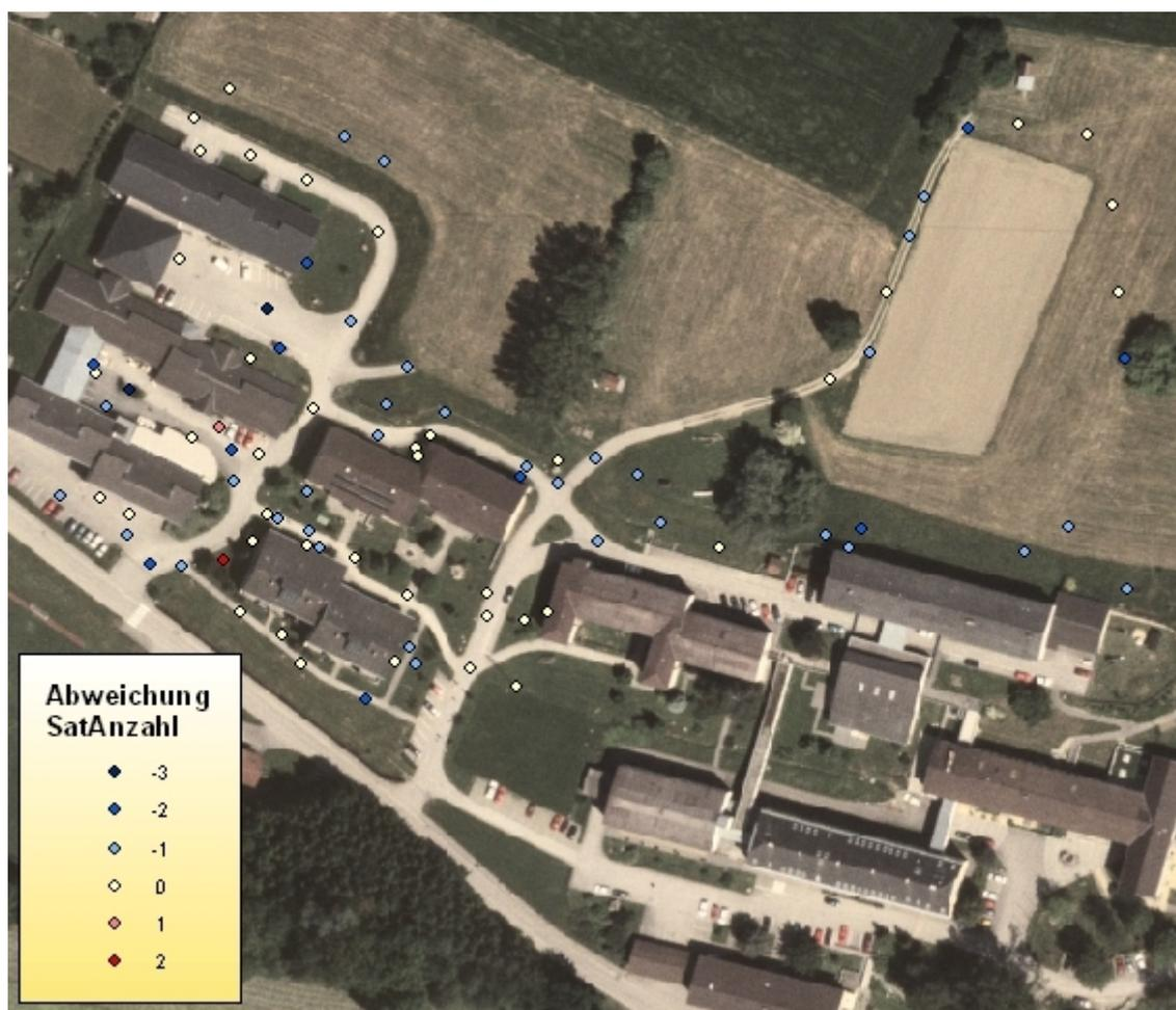
Abbildung 5.1: Visualisierung der gemessenen Kontrollpunkte in Peuerbach mit hinterlegtem digitalen Orthophoto
