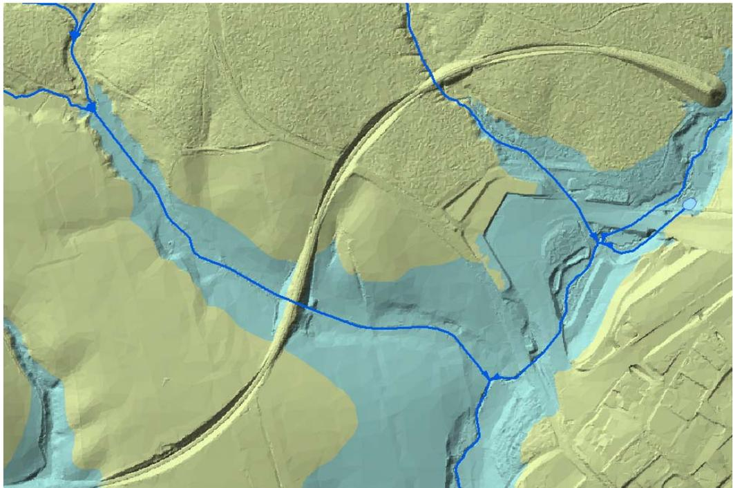
*Abbildung 55: Der Verlauf einer Bahntrasse durch das Gelände. Anschüttungen von Dämmen und Abtragungen des Geländes sind gut zu erkennen.*
