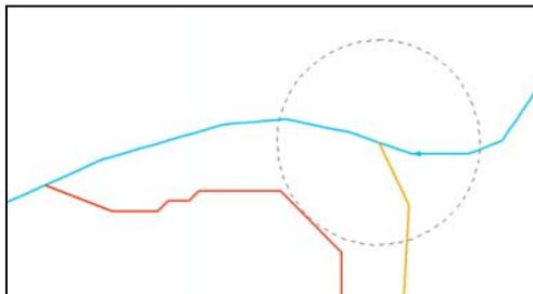
Abbildung 80: Schritt 3: Erstellung einer Pufferfläche in einem definierten Umkreis, um den Einmündungspunkt des Lückenschlusses aus Schritt 2 (gelb). In diesem Fall erhält der Lückenschluss aus Schritt 1 (rot) das Attribut „falsch“.
