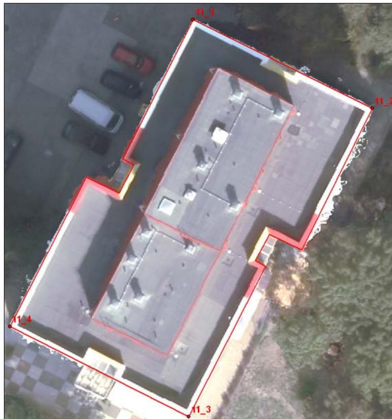
Abbildung 4.11: UltraCam<sub>D</sub>, digitalisierte Kanten und Eckpunkte.
