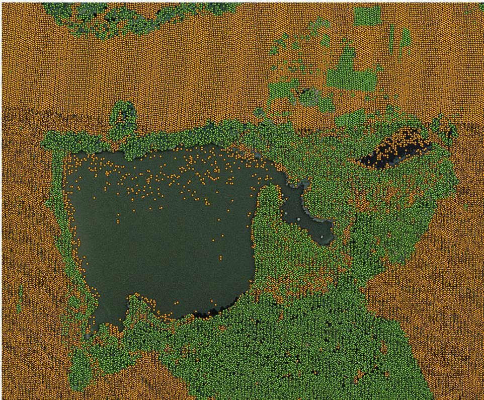
**Abbildung 4-6: Niedrige Laser-Reflexionsrate aufgrund der hohen Absorption; Hochpunkte erscheinen grün, Bodenkunkte braun**
