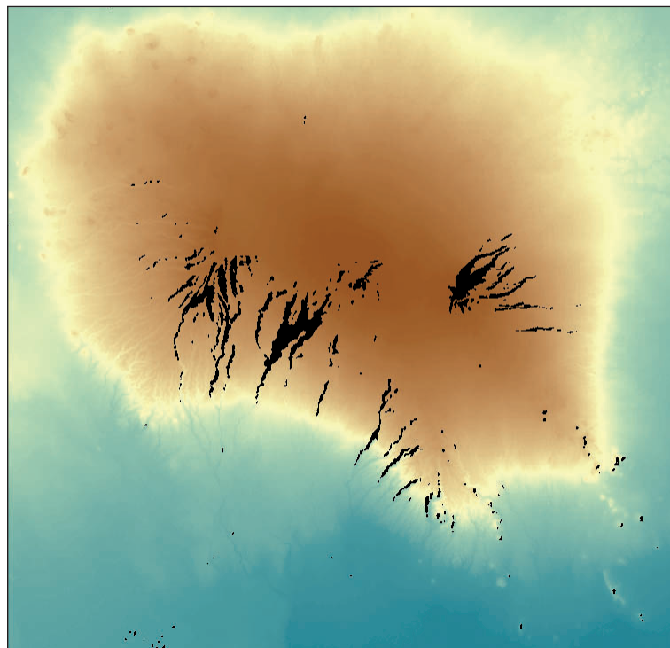
Abbildung 4.6 SRTM3-Daten für das Gebiet von 37° – 37°41 östl. L. und 2°48 – 3°28 südl. Br.: Über das SDDS bezogene DEM-Daten wurden als GeoTIFF in ArcMap 8.3 geladen und visualisiert (Darstellung: „Stretched, Type: Histogram Equalize, Invert“ mit kontinuierlicher Farbskala „Brown to Blue Green Diverging, Bright“ für Höhenwerte von 704 – 5884 m und Schwarz für NoData-Zellen, 800 Zeilen x 820 Spalten, Bildschirmbild)
