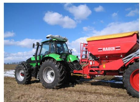
Abb.: 2 Der auf dem Schlepperdach montierte Yara N-Sensor (Werkbild AGRICON)
