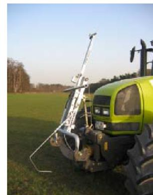
Abb.: 4 CROP-Meter am Traktor montiert (Werkbild Agrocom)
