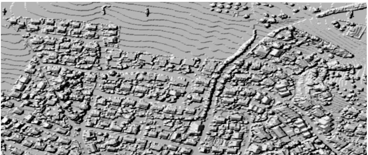
Abbildung 13_Schummerungsdarstellung des DOM (eigene Darstellung in ArcGIS)
