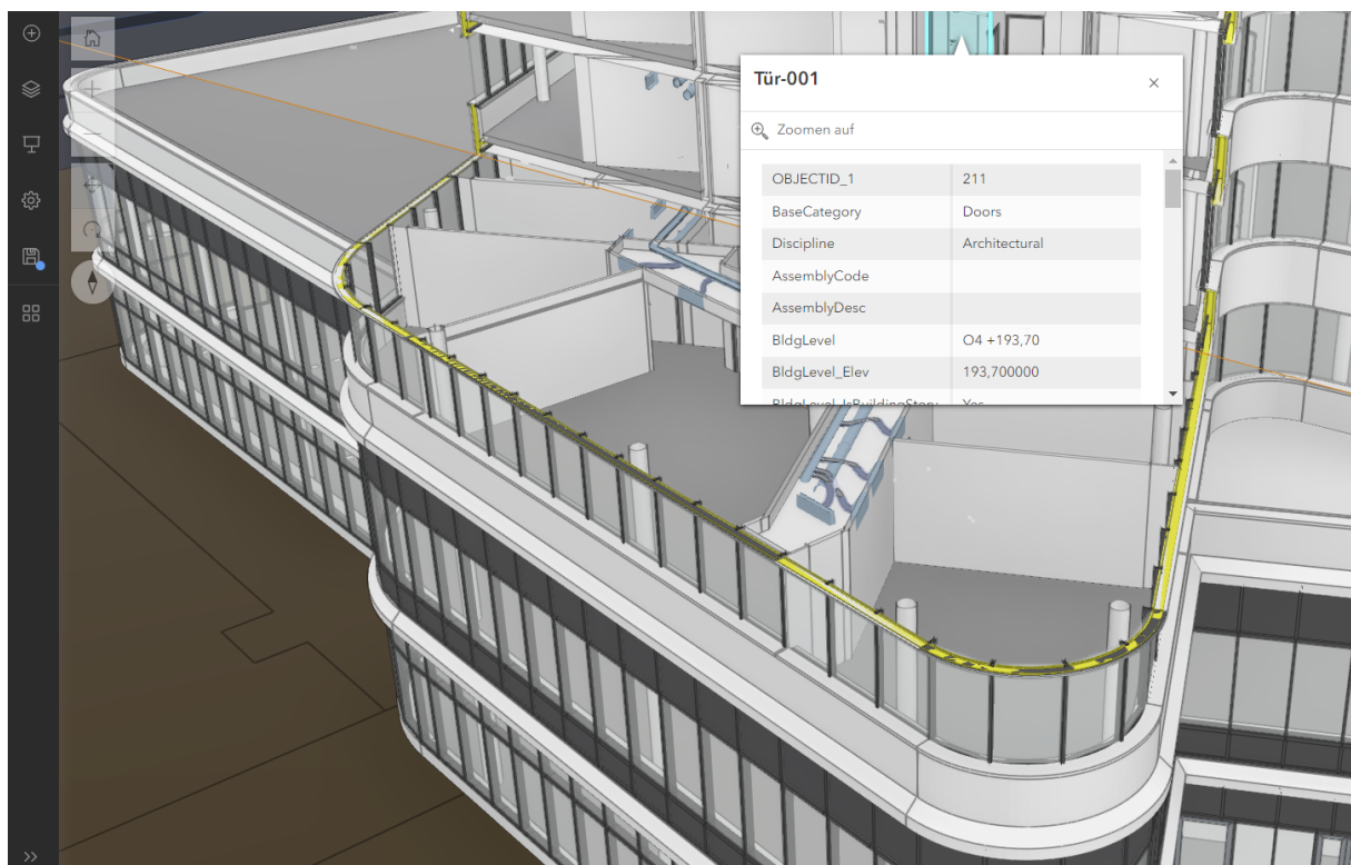
Abb. 4.2: Detaillierungsgrad und Attributierung der transformierten Modelle
