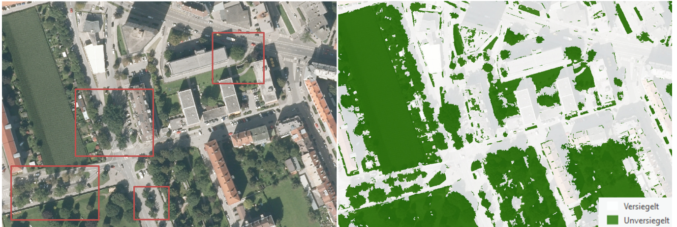
Abbildung 35: Eingeschränkte Sicht auf die Bodenversiegelung durch flugzeuggestützte Fernerkundungsdaten
