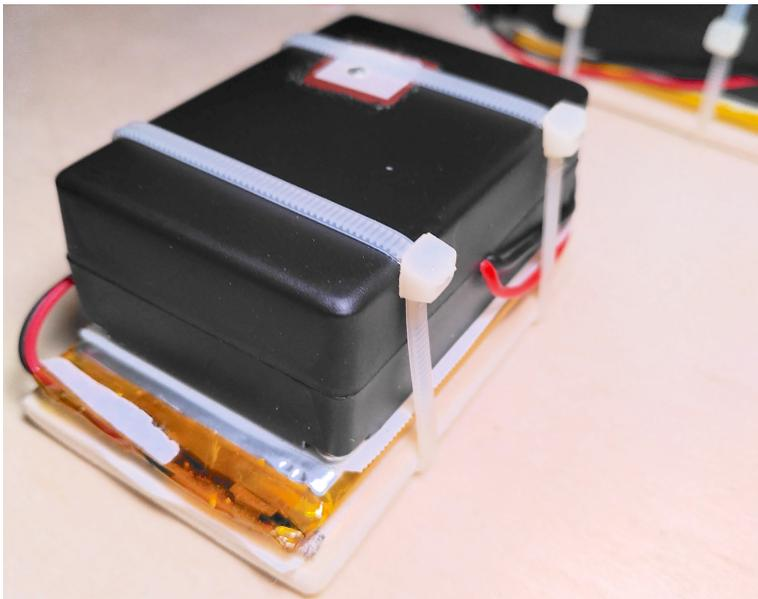
Abbildung 2.9.: Fertig montierter GPS-Tracker der ersten Generation ohne Hülle
