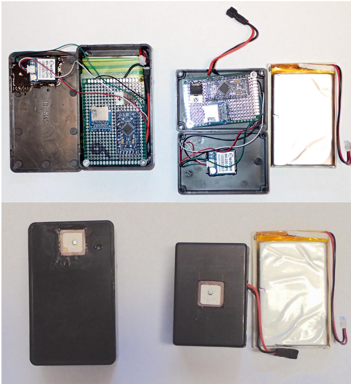
Abbildung 2.14.: Links: GPS-Tracker der 2. Generation
