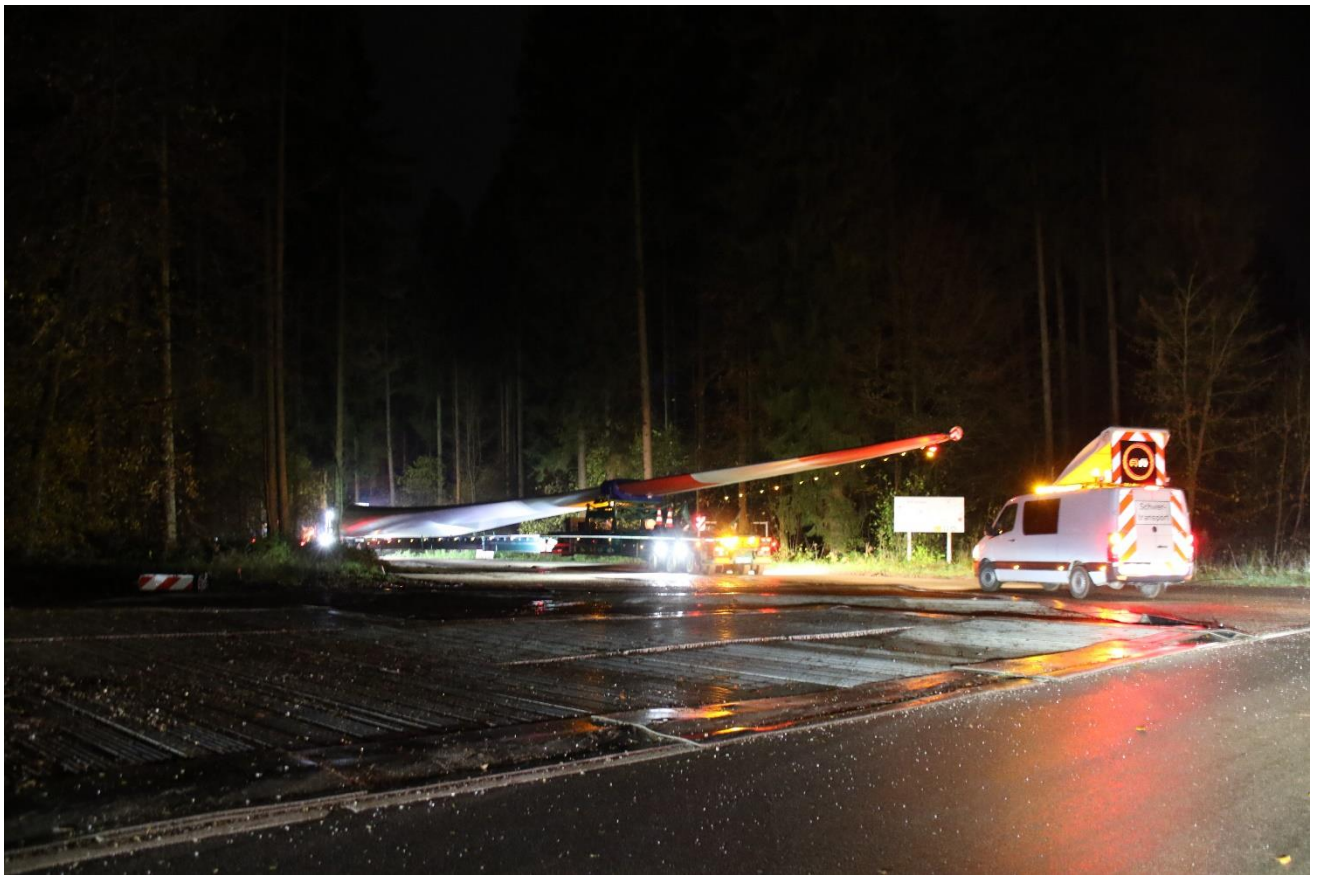
Abbildung 12: Nächtlicher Transport eines Rotorblatts zum Windpark Bad Saulgau mit drei Anlagen Vestas V136 im Jahr 2019. Durch die Kulisse werden die Dimensionen des Spezialtransports deutlich. Das Blatt hat eine Länge von ca. 66 m. Bei aktuellen Anlagen messen die Blätter an die 86 m (Quelle: eigene Aufnahme).
