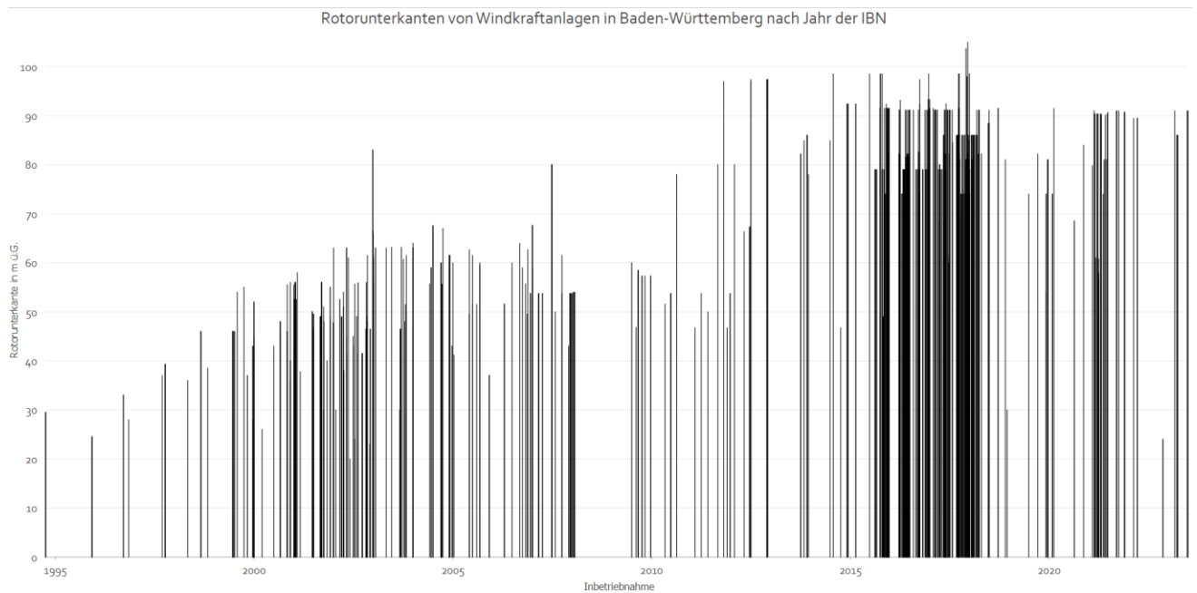
Abbildung 52: Höhen der Rotorunterkanten in m ü.G. von Windkraftanlagen in Baden-Württemberg nach dem Jahr ihrer Inbetriebnahme (eigene Darstellung, Datengrundlage: https://udo.lubw.baden-wuerttemberg.de , abgerufen am 25.07.2023).
