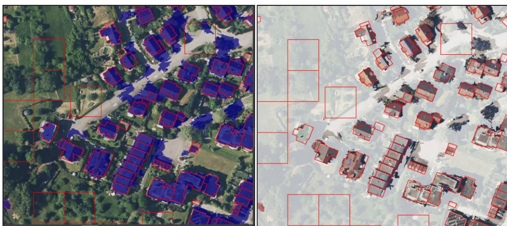
Abbildung 52 – Beispiel 1: CNN-Klassifizierung der Zielklasse "Gebäudeobjekte" (blaue Flächen), sowie der Nicht-Zielklasse „Nicht-Gebäude“ (weiße Fläche) im Vergleich zur Ground-Truth -Klasse „Gebäudeobjekte“ (rote Gebäudeumringe) und „Nicht-Gebäude“ (rote regelmäßige Quadrate)
