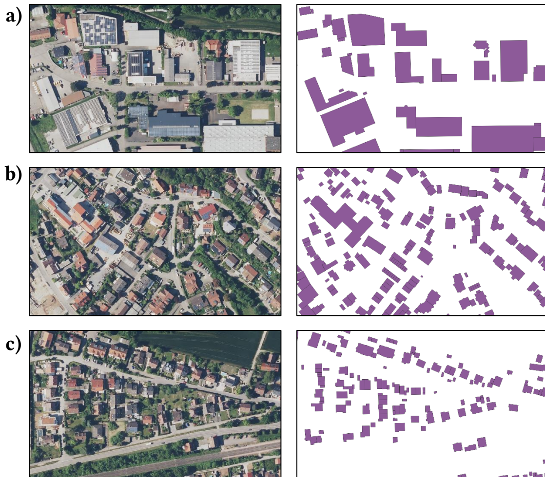
Abbildung 8 - Darstellung der Intra-Klassen-Heterogenität innerhalb der Klasse „Gebäudeobjekte“ a) gewerbliche Objekte b) Mischbebauung c) Einzelhausbebauung
