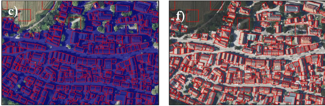
Abbildung 55 - Beispiel der CNN-Klassifizierung der Zielklasse "Gebäudeobjekte" (blaue Flächen a-c) und der Nicht-Zielklasse „Nicht-Gebäude“ (graue Fläche d-f) im Vergleich zur Ground-Truth -Klasse (rote Umringe)
