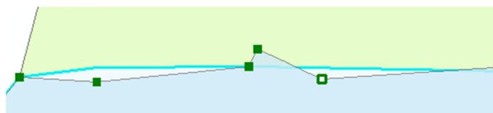
Abbildung 28: Overlaps und Sliver-Polygone - fehlerhafte Quelldaten
