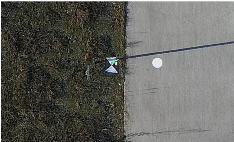
Abbildung 1-6: Luftbildplatte neben einem kreisförmigen GCP aus 120m Flughöhe (vergrößerte Darstellung)
