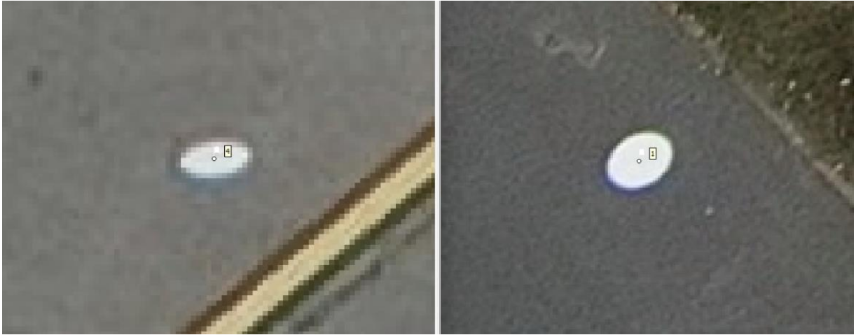
Abbildung 4-3: Vergleich von Ausschnitten aus Oblique-Aufnahmen mit einem Aufnahmewinkel von 45^\circ bei ca. 90m Flughöhe. Der linke Ausschnitt befindet sich am oberen Bildrand und weist dadurch eine Höhere Verzerrung als der rechte Bildausschnitt auf, welcher sich eher am unteren Bildrand befindet. Zudem besteht die Darstellung aufgrund der Entfernung aus weniger Pixeln.
