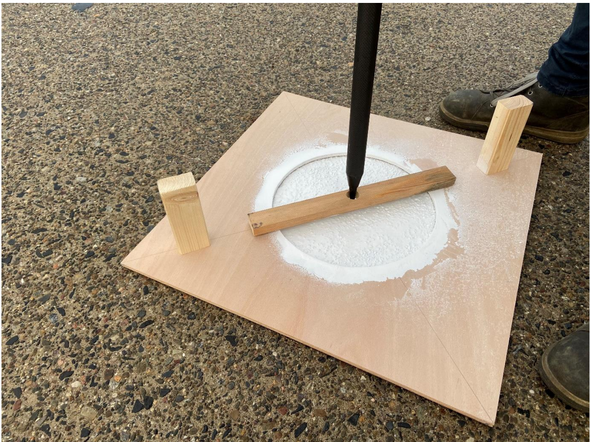
Abbildung 2-11: Die selbstkonstruierte Sprühschablone im Einsatz. Hier befindet sich der Lotstab des GNSS-Messgerätes bereits in der Zentriervorrichtung.
