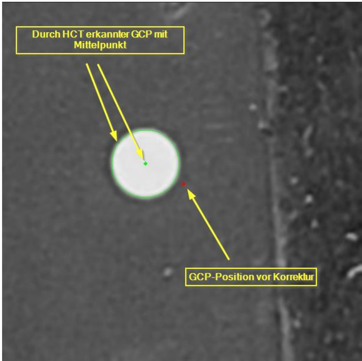
Abbildung 3-1: Beispiel eines durch HCT erkannten GCPs. Die gelben Elemente wurden zur Veranschaulichung in Nachhinein hinzugefügt.
