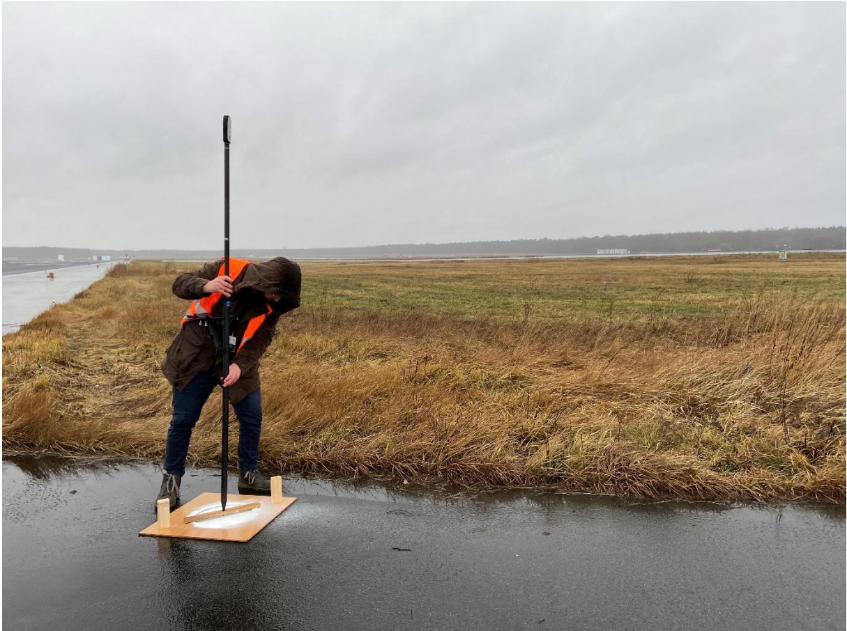
Abbildung 2-14: Einmessen des neuen GCP's mit per GNSS-Messgerät
