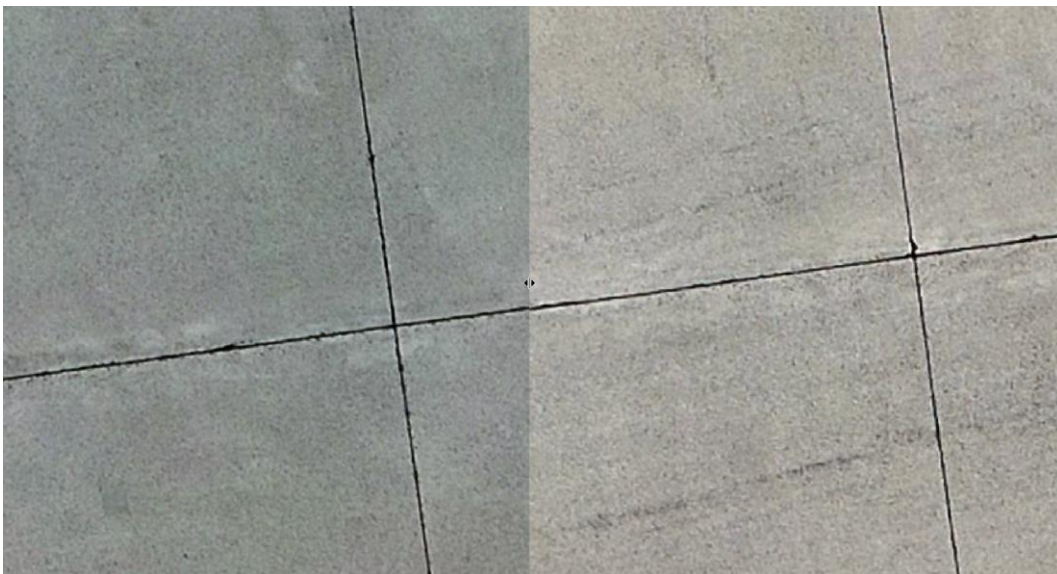
Abbildung 4-5: Beispiel Vergleich Befliegung 1 (links) mit Befliegung 4 (rechts) bei einem Maßstab von 1:20 über SWIPE-Tool in ArcGIS Pro. Ein minimaler Versatz ist erkennbar.
