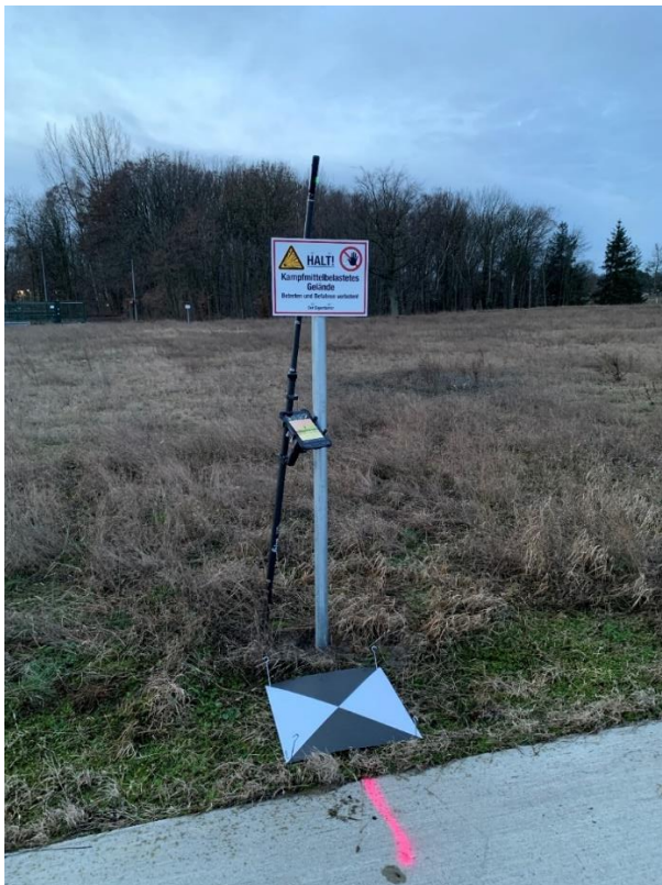
Abbildung 1-5: GCP in Form einer Luftbildplatte
