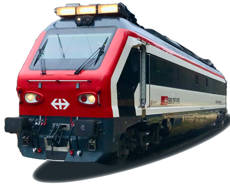
Figure 1.0.2: Selbstfahrendes Diagnosefahrzeug (DFZ) der SBB
