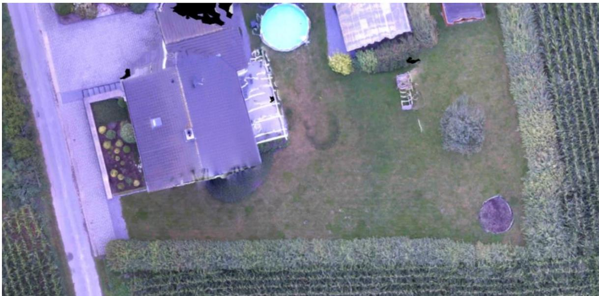
Abbildung 14: Das durch ODM erzeugte digitale Orthofoto.
