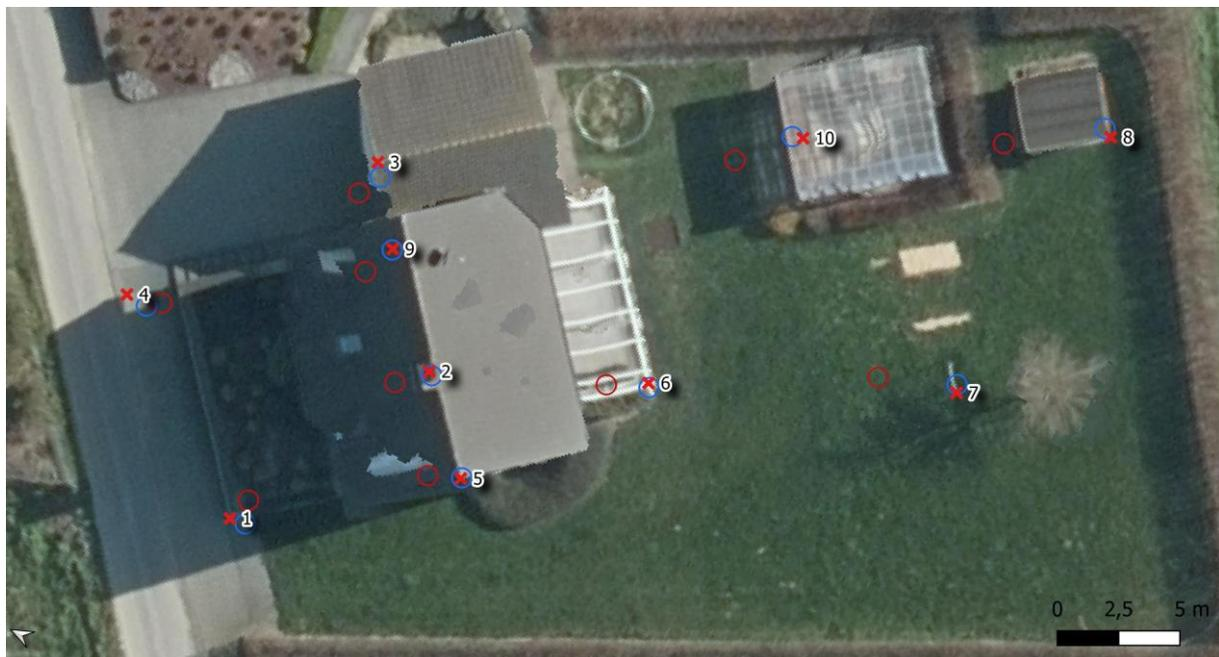
Abbildung 15: Referenz-Orthofoto (DOP10) mit überlagerten Referenz- und Vergleichspunkten. Rote Kreuze: Referenzpunkte, rote Kreise: Vergleichspunkte der Georeferenzierung ohne PPK-Nachkorrektur, blaue Kreise: Vergleichspunkte der Georeferenzierung mit PPK-Nachkorrektur.
