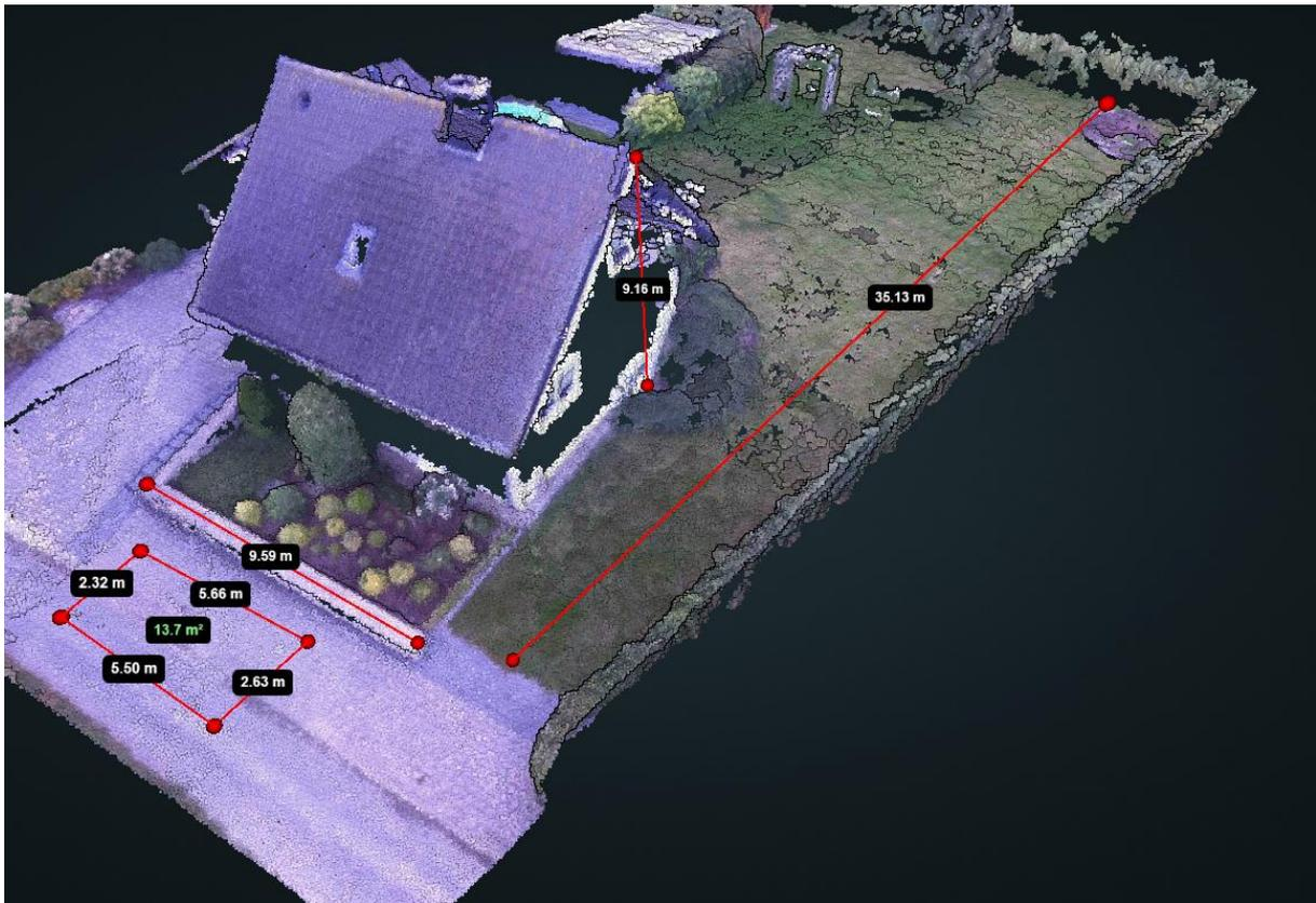
Abbildung 13: Die durch ODM erzeugte 3D-Punktwolke. Visualisiert mit zusätzlichen metrischen Angaben (Strecke, Höhe, Flächengröße) über die Anwendung Potree.
