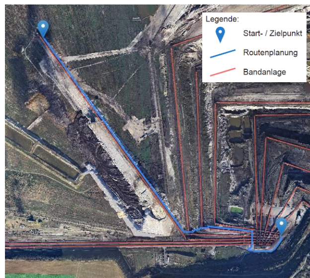
Abbildung 32: Routenplanung, Bandsammelpunkt bis zur Kopfstation-A5
