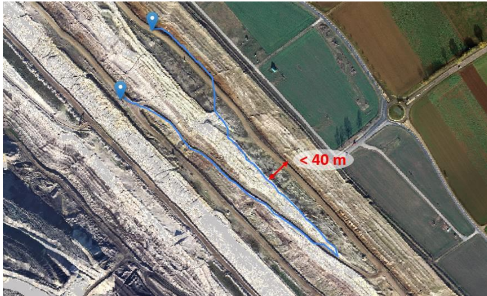
Abbildung 44: Sohlenbreite im Randböschungsbereich
