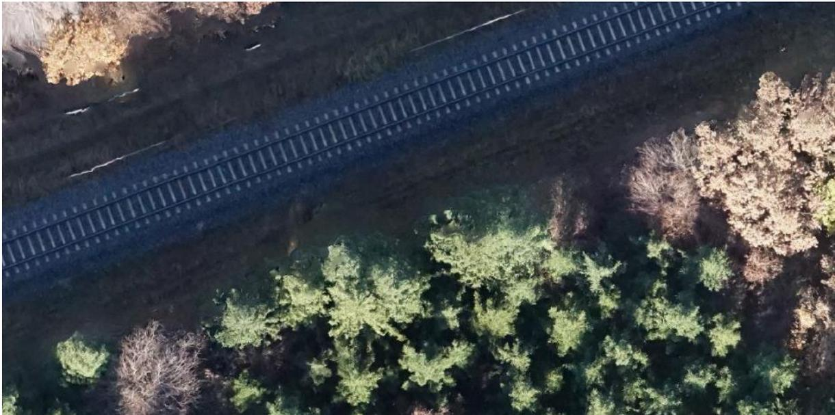
Abbildung 59 Detailansicht des Orthomosaiks der herkömmlichen Flugplanung mit vier Flugstreifen und rein senkrecht ausgerichteten Bildern
