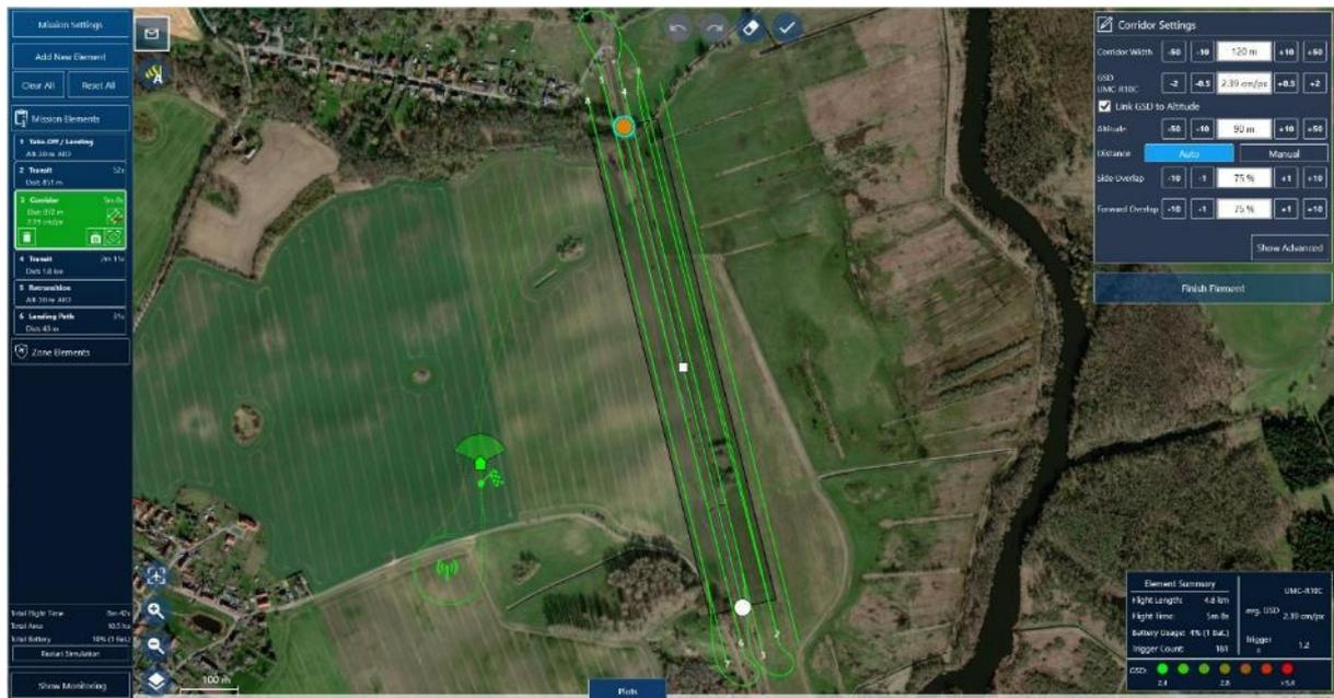
Abbildung 4: Beispielhafter Flugplan der Fahrwegdienste mit vier Flugstreifen in einer Flughöhe von 90m mit einer Bildüberlappung von 75% 75
