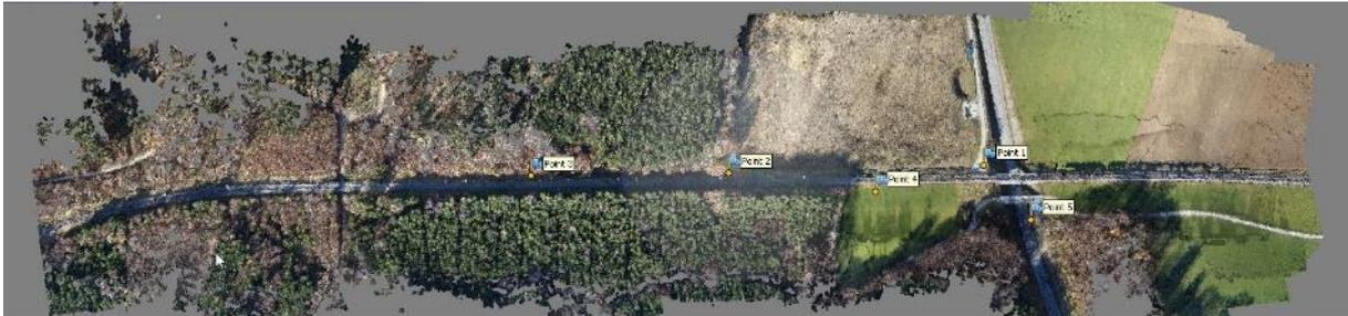
Abbildung 45 Dichte Punktwolke aus Agisoft Metashape-Flug mit zwei Flugstreifen in 90 m mit nadir und ca. 20° oblique ausgerichteter Kamera
