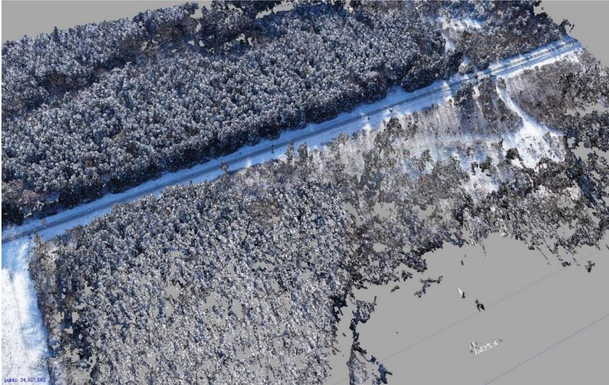
Abbildung 57: Dichte Punktwolke bei 90m AGL in 40m Abstand vom Gleis, niedrig
