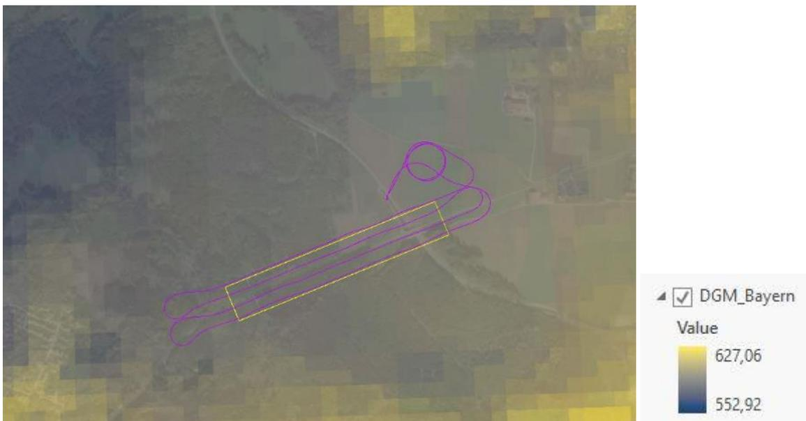
Abbildung 26 Überlagerung von Höhendaten der Bayerischen Vermessungsverwaltung und dem ESRI World Imagery Service, sowie Anzeige eines Flugpfades als KML-Datei
