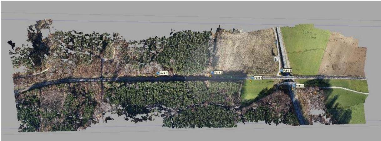
Abbildung 52 Dichte Punktwolke aus Agisoft Metashape Flug mit zwei Flugstreifen in 90 m mit nadir und ca. 20° oblique ausgerichteter Kamera zum Gleis und weg vom Gleis
