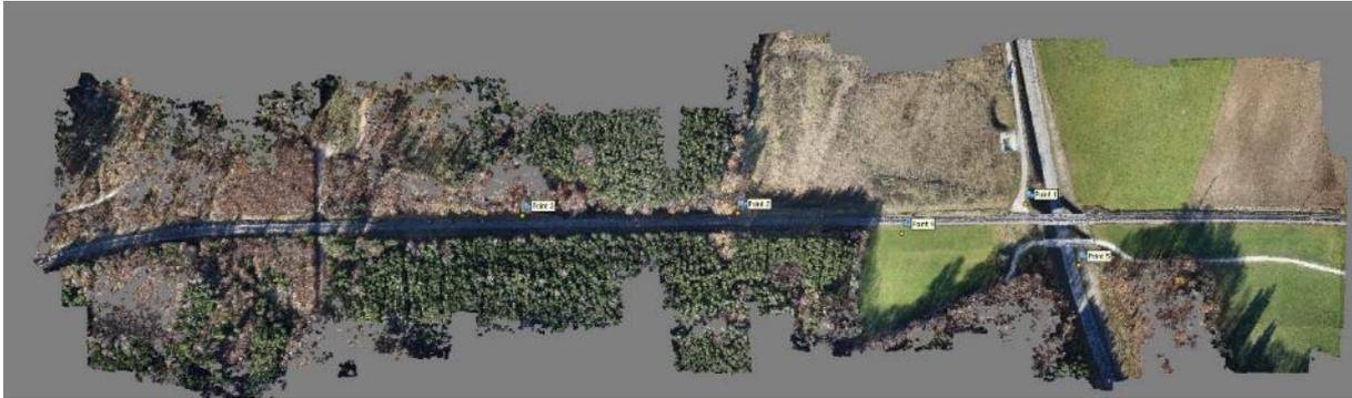
Abbildung 34 Dichte Punktwolke aus Agisoft Metashape Flug mit vier Flugstreifen in 90 m Höhe ausgerichteter Kamera
