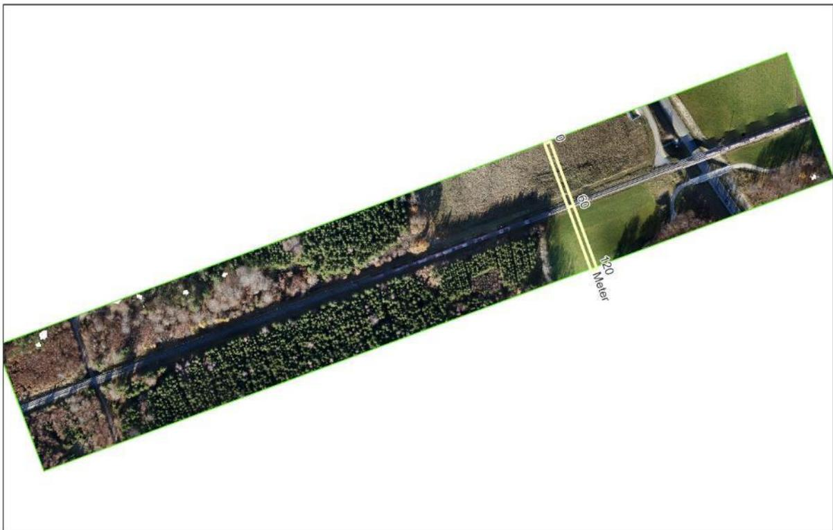
Abbildung 55 Orthomosaik der Befliegung mit zwei Flugstreifen in 90 m Flughöhe, mit drei Kamerablickrichtungen, begrenzt auf einen 120 m breiten Korridor
