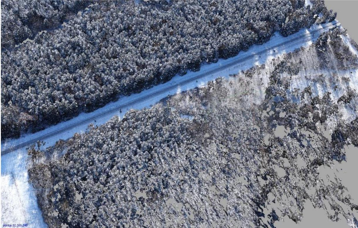
Abbildung 58 Dichte Punktwolke durch einen Flug in 90m AGL in 50m Abstand vom Gleis, nadir und 35° geneigt
