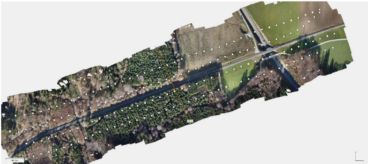
Abbildung 38 Das komplette Orthomosaik der Befliegung mit vier Flugstreifen in 90 m Höhe mit den Bildpositionen
