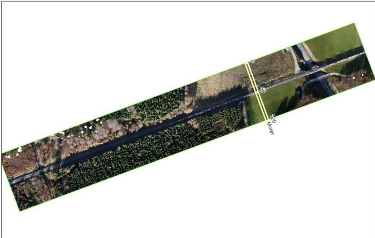
Abbildung 47: Orthomosaik der Befliegung mit zwei Flugstreifen in 90 m Flughöhe, begrenzt auf einen 120 m breiten Korridor
