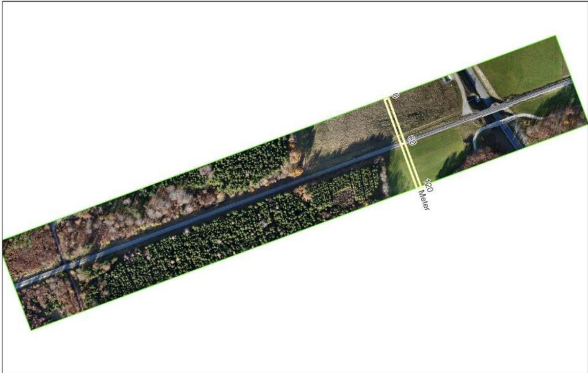
Abbildung 40 Orthomosaik der Befliegung mit vier Flugstreifen in 80 m Flughöhe, begrenzt auf einen 120 m breiten Korridor
