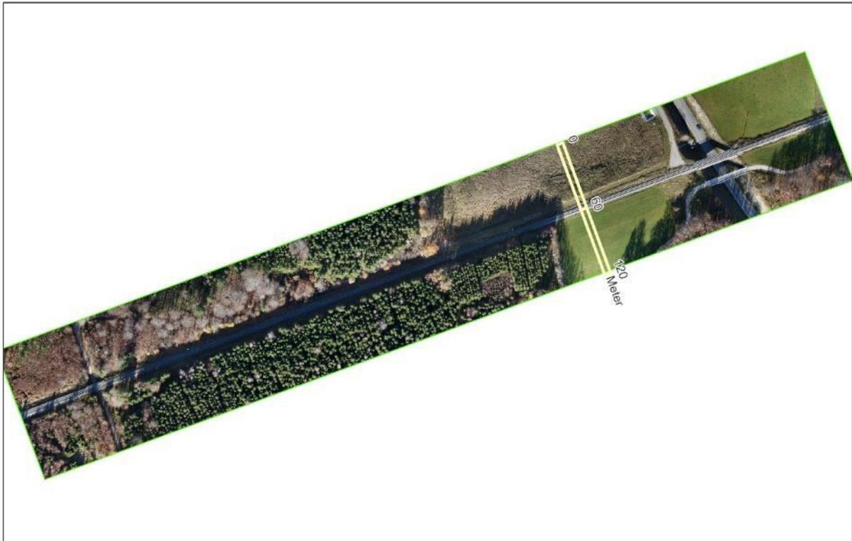
Abbildung 37 Orthomosaik der Befliegung mit vier Flugstreifen in 90 m Flughöhe, begrenzt auf einen 120 m breiten Korridor
