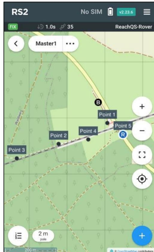
Abbildung 22 Verteilung der eingemessenen Checkpoints entlang der Versuchsstrecke
