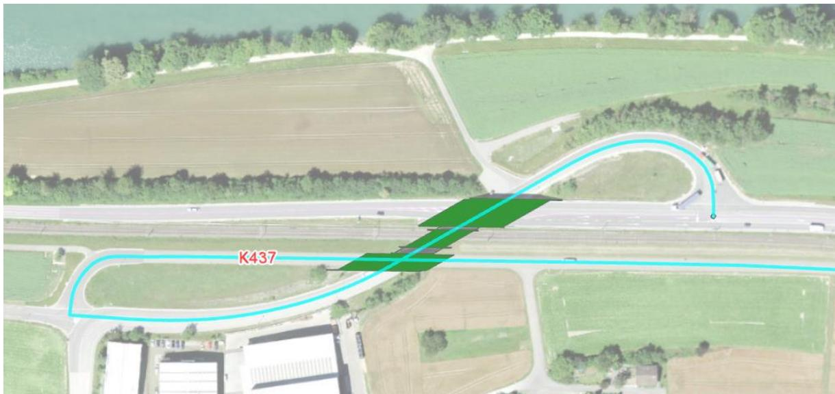
Abbildung 13: Beispiel einer Unterführung welche durch den Kunstbauten-Grundriss (grün) erkannt wurde. Das Segment der K437 ist beim Schnittpunkt nicht unterbrochen, sondern verläuft durchgehend.
