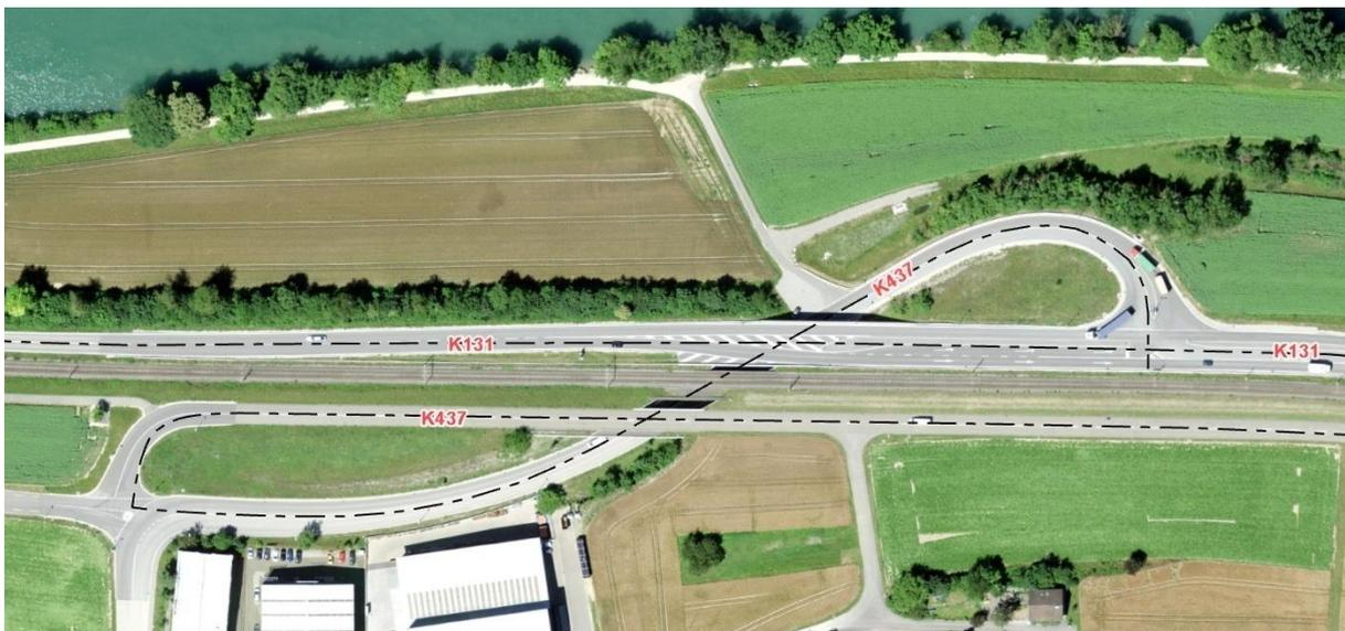
Abbildung 7: Beispiel einer «Self-Intersection». Die K437 kreuzt sich auf zwei unterschiedlichen Ebenen. Sie verläuft durch die Unterführung, über welche sie nach einer Kurve führt. Zusätzlich führt die K437 in einer Unterführung unter der K131 durch.
